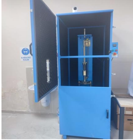
Şekil 4.17. Marshall stabilite deney tokmağı
