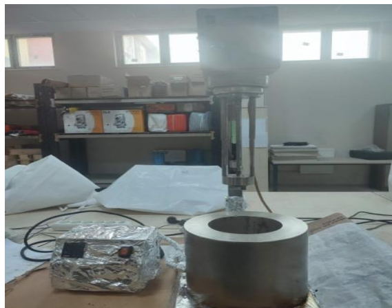
Şekil 4.8. Kendinden ısıtıcılı High Shear Mikser
