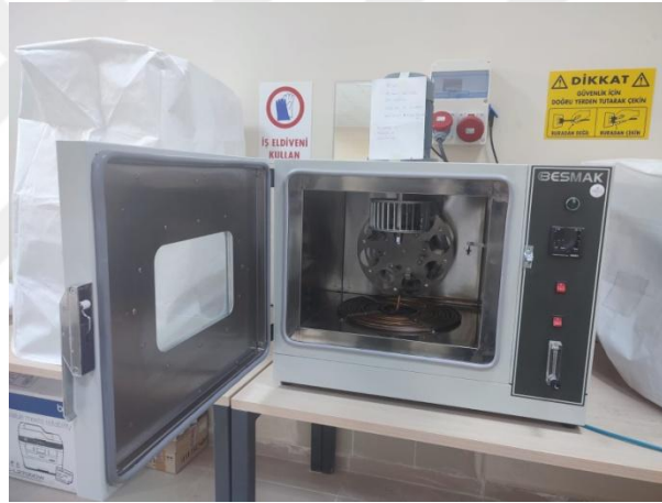
Şekil 4.12. RTFOT (Dönel İnce Film Isıtma Kaybı Deney) Cihazı
