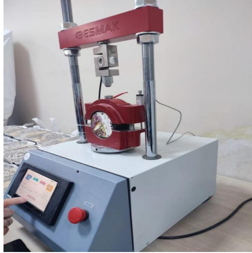
Şekil 5.11. Marshall stabilite ve akma deney cihazı
