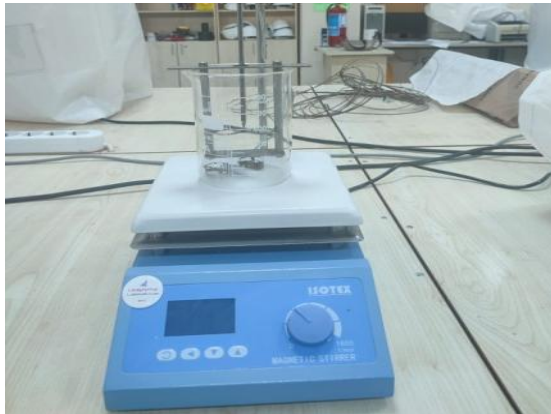
Şekil 4.10. Yumuşama noktası deney aleti
