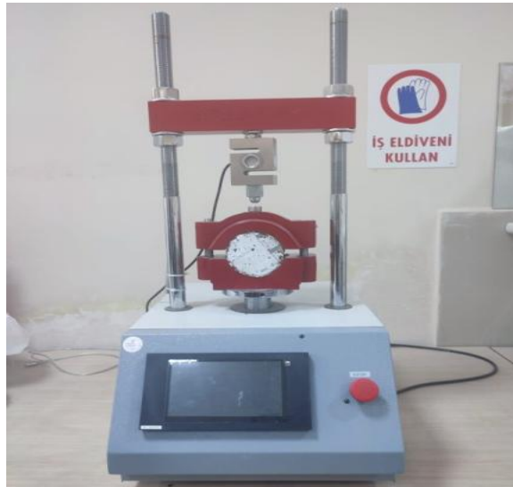
Şekil 4.16. Marshall stabilite deney aleti
