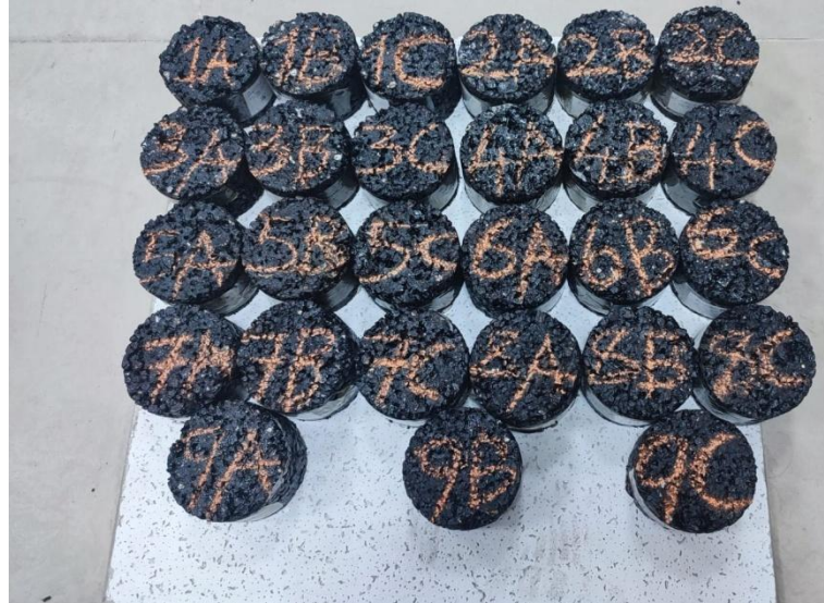
Şekil 5.9. Kuru ağırlıkları alınmış, isimlendirilmiş briketler
