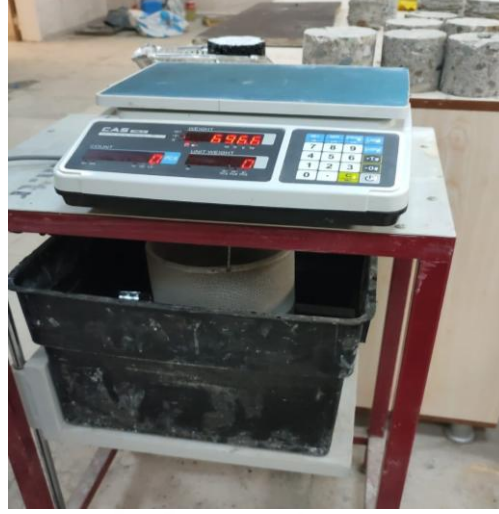
Şekil 5.10. Sudaki ağırlıkların tartıldığı Arşimet terazisi
