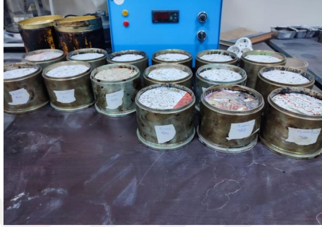
Şekil 4.20. Kalıplara yerleştirilip sıkıştırılmış numuneler
