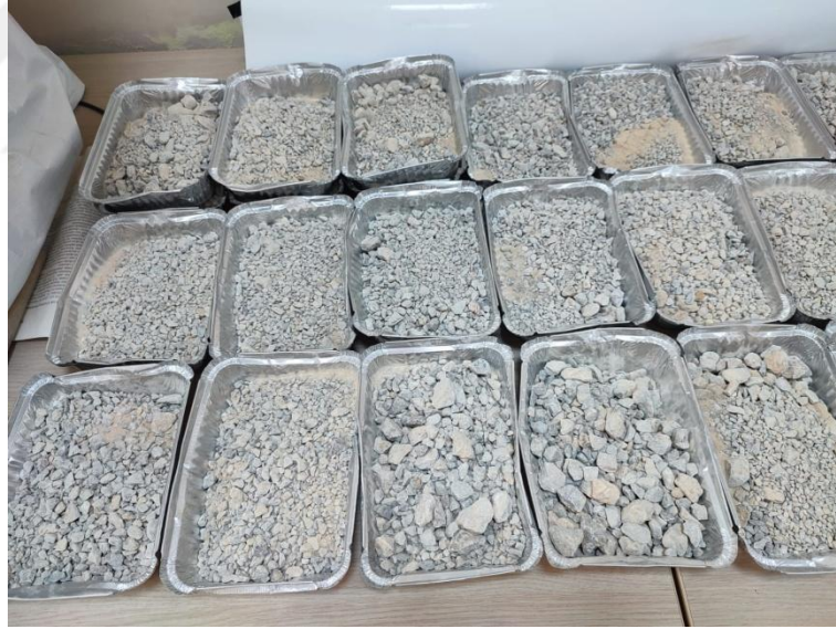
Şekil 5.7. 1150'şer gram olarak tartımı yapılmış kuru agregalar
