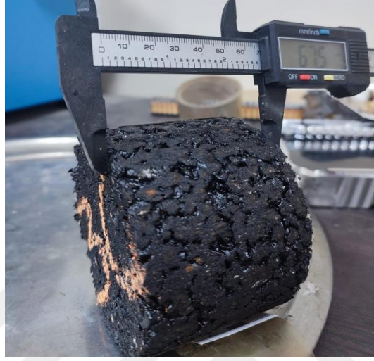
Şekil 4.21. Numunelerinin 3 boyutunun ölçülmesi
