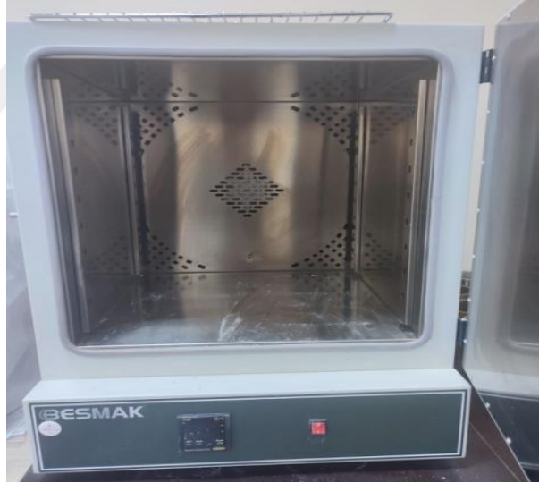
Şekil 4.19. Deney malzemelerinin ısıtıldığı etüv
