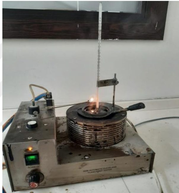
Şekil 4.11. Parlama noktası deney aleti
