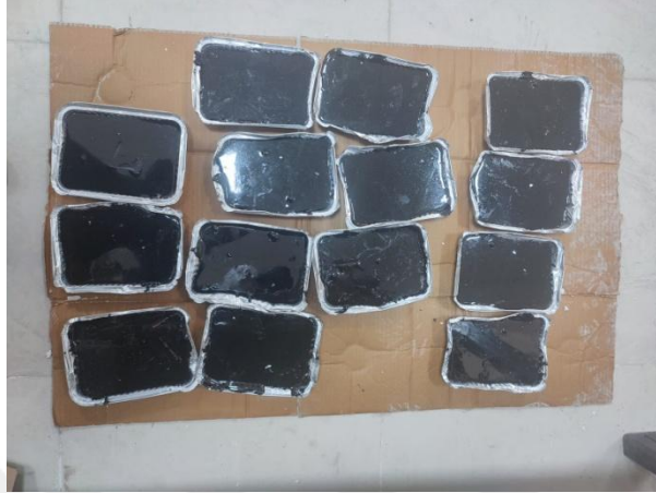
Şekil 4.7. Değişik parametre ve seviyelerde karıştırılarak hazırlanmış bitüm numuneleri
