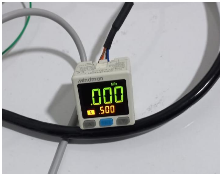
Şekil 7.5 Deneyde kullanılan basınç sensörü.
