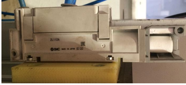
Şekil 6.16 Projede kulolanılan Vakum Üreteci.
