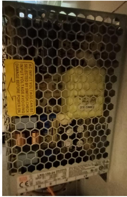
Şekil 6.22 Projede kullanılan güç kaynağı.
