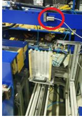
Şekil 7.2 Deneyde kullanılan titreşim sensörünün bağlantı yeri.
