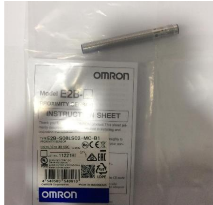
Şekil 6.17 Projede kullanılan M8 Endüktif Sensör.
