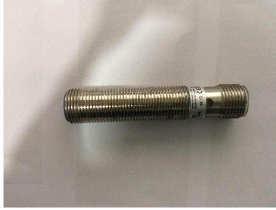
Şekil 6.15 Projede kullanılan M12 Endüktif Sensör.
