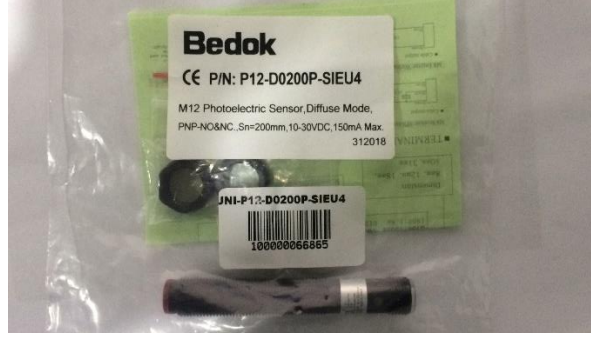
Şekil 6.20 Projede kullanılan fotosel sensör.
