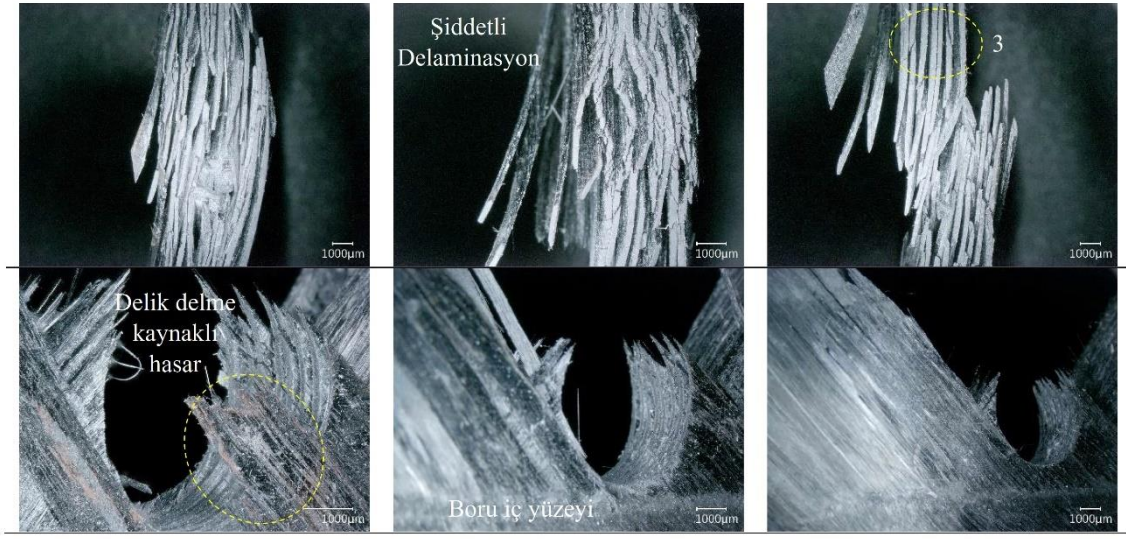
Şekil 4.46 (Devam) Filaman sarım için %70 gerilme seviyesinde yüklenmiş numunelerin hasar görüntüleri ve mikroskopik hasar analizi.
