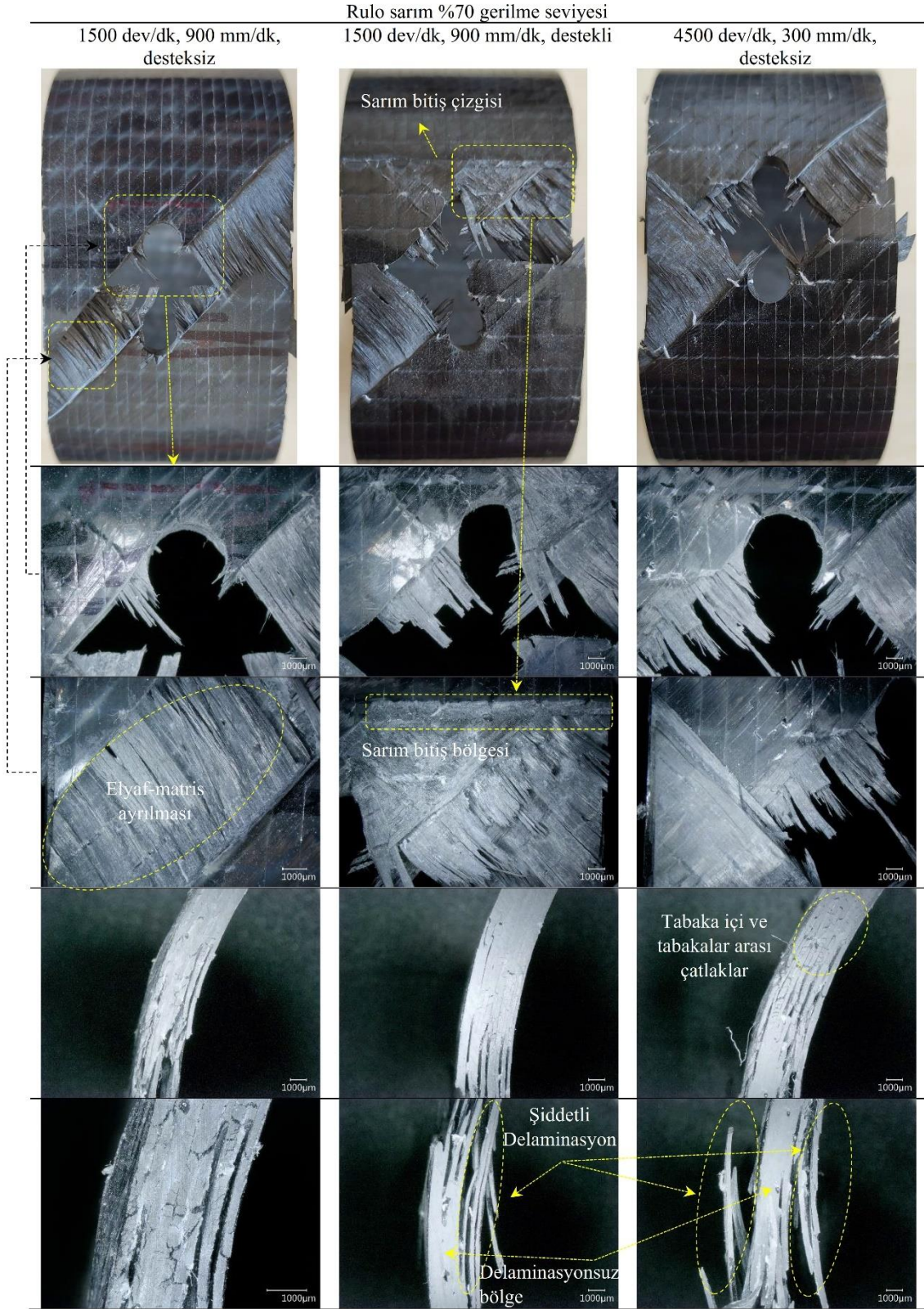
Şekil 4.49 Rulo sarım için %70 gerilme seviyesinde yüklenmiş numunelerin hasar görüntüleri ve mikroskobik hasar analizi.
