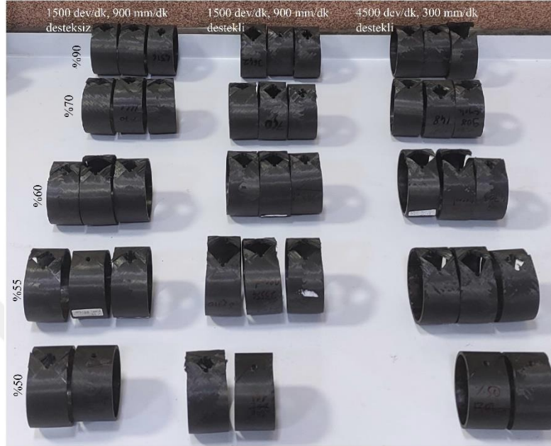
Şekil 4.28 Yorulma testleri sonrası hasara uğramış filaman sarım numuneler.
