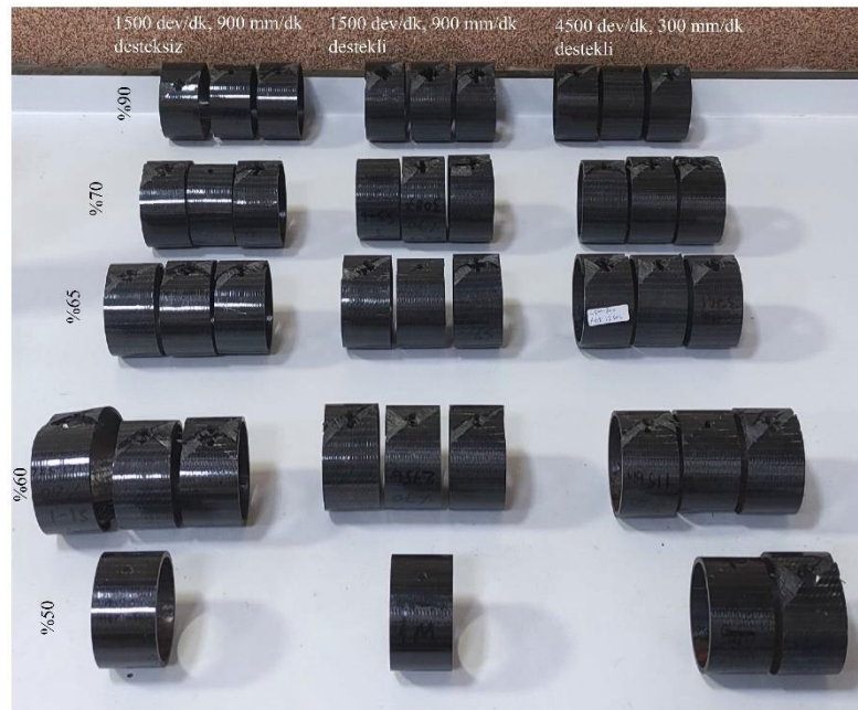
Şekil 4.29 Yorulma testleri sonrası hasara uğramış rulo sarım numuneler.
