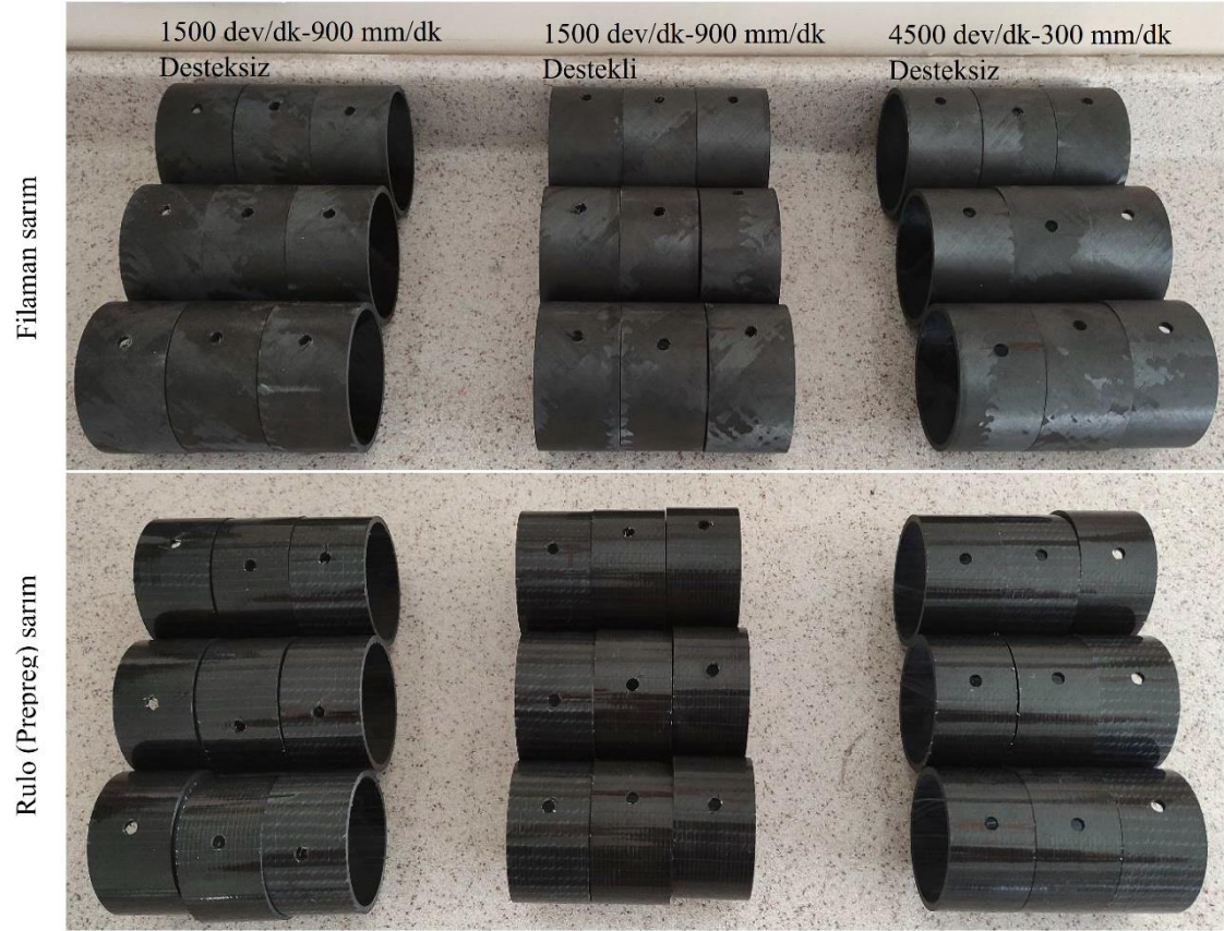
Şekil 3.11 Halka çekme ve yorulma testi numuneleri.
