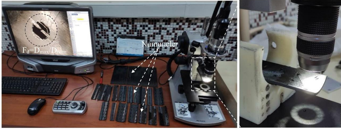
Şekil 3.7 Delaminasyon hasarının ölçümü (Morkavuk vd. 2022a).
