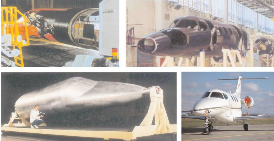
Şekil 1.1 Polimer kompozitlerin havacılık sektöründeki kullanımı (Hafif yolcu uçağı Premier I'nin karbon elyaf kompozit gövdesi) (Kolesnikov ve Herbeck 2004).
