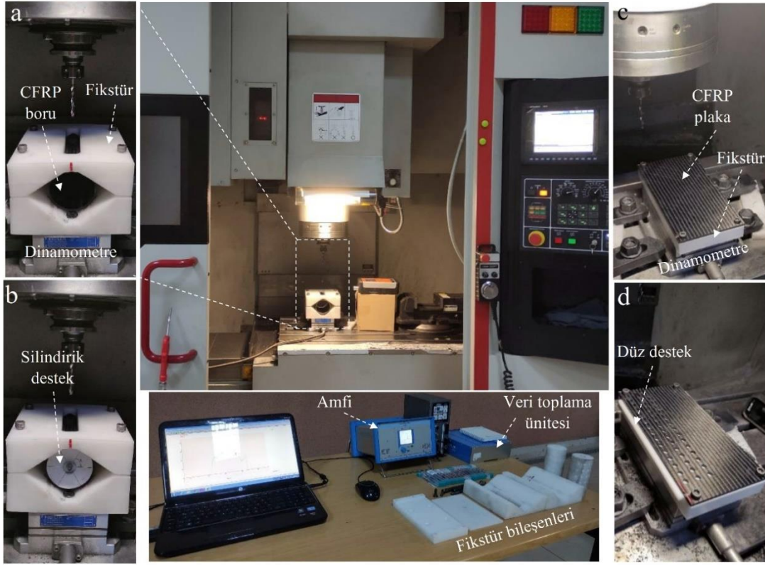
Şekil 3.3 Delik delme testleri için deney düzeneği, (a) CFRP borunun desteksiz delinmesi, (b) CFRP borunun destek kullanılarak delinmesi, (c) CFRP plakanın desteksiz delinmesi, (d) CFRP plakanın destek kullanılarak delinmesi (Morkavuk vd. 2022a).
