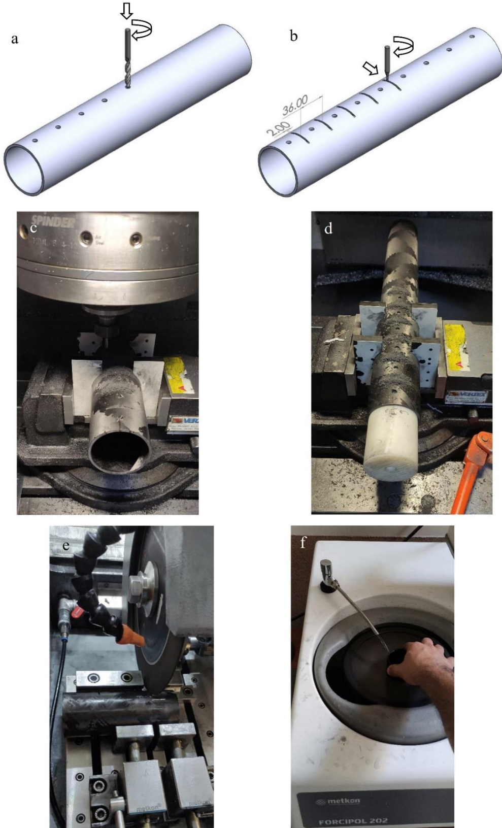
Şekil 3.10 Halka çekme testi için numune hazırlama aşaması, (a) delik delme işlemi şematik görünümü, (b) frezeleme işlemi şematik görünümü, (c) desteksiz delik delme işlemi, (d) destekli delik delme işlemi, (e) abrasif kesme işlemi, (f) zımparalama işlemi.
