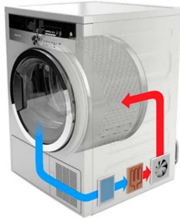
Şekil 2.4 Kurutma makinesi kurutma mekanizması
