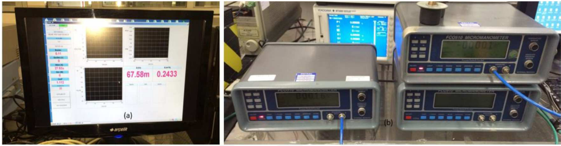
Şekil 3.3 Veri toplama sistemi (sol), mikro manometreler (sağ)
