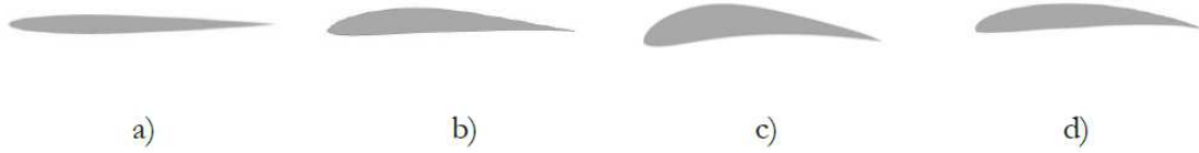
Şekil 1.10 Analiz edilen fan kanat yapıları: a) Naca 0006, b) E 387, c) Eppler 421, d) SG 6043
