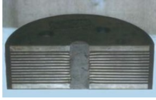
Şekil 2.13 Kurşun çekirdekli kauçuk izolatör [29]
