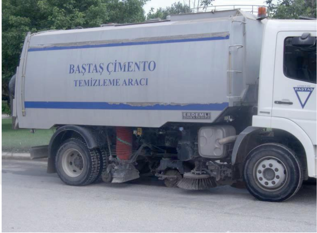
Şekil 2.14: Araç geçişlerinin olduğu yollarda biriken tozu vakum yaparak ve filtreleyerek kendi deposuna çeken süpürge aracı resim
