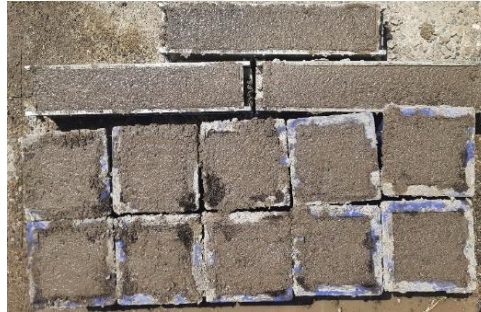
Şekil 5.41: Beton basınç dayanımını belirlemek için alınmış numuneler.
