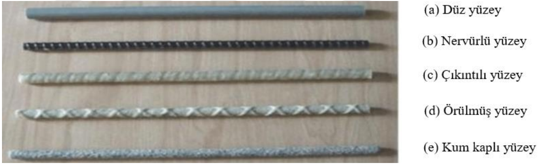
Şekil 2.3: FRP donatı çubuğu yüzey özellikleri (Abedini ve diğ., 2017).
