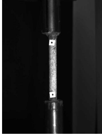
Şekil 5.31 : GFRP donatı çubuğu çekme deneyi.
