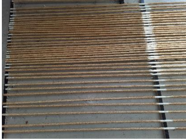
Şekil 5.34 : Kum kaplanma sonrasında k rlenmeye bırakılmış GFRP donatı  ubukları.
