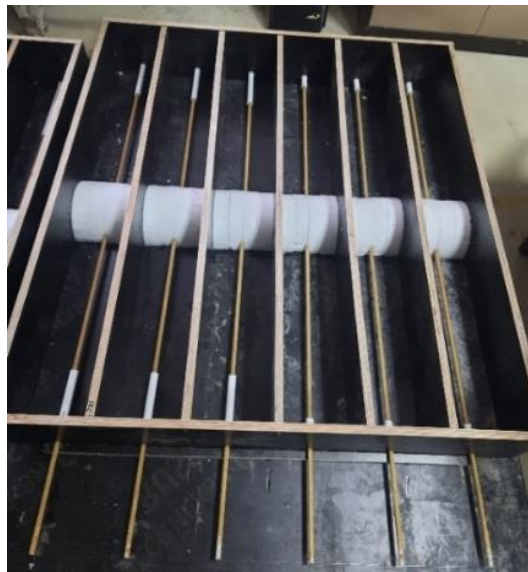
Şekil 5.39 : Kiriş numunelerine yarım daire formu verilmiş strafor yerleştirildikten sonraki görünümü.
