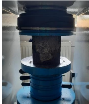
Şekil 5.32 : Beton eksenel basınç deneyi.
