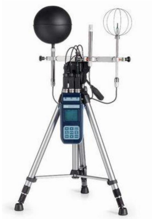
Şekil 3.3: Delha Ohm Markalı Termal Ölçüm Cihazı
