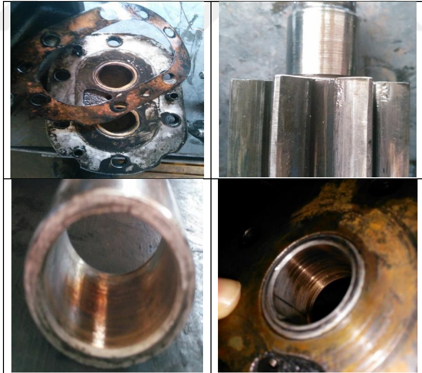
Şekil 1.1. Yatak sarması sonucu hasar almış yağ pompası ekipmanları (Sayar, 2017)
