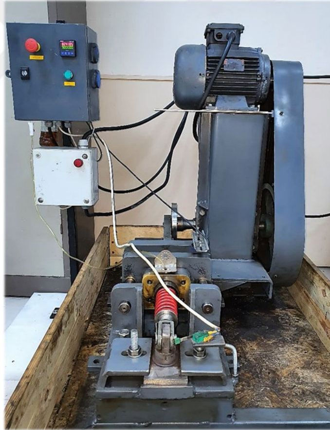
Şekil 4.17: Yapıştırma bağı için geliştirilen yorulma test cihazı.
