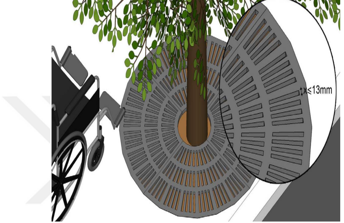
Şekil 2.29. Ağaç ızgara teknik detayı (Engelsiz Tasarım Kılavuzu, 2022)
