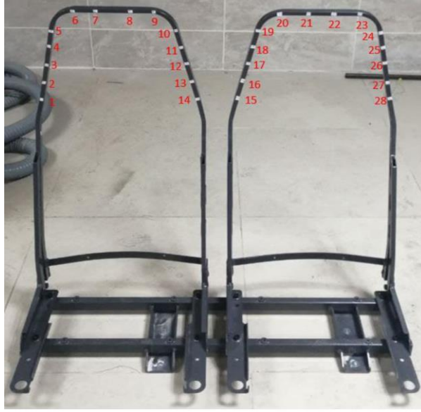
Şekil 2.13: Yolcu koltuğunun metal iskeleti.
