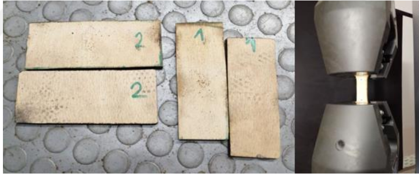
Şekil 2.9: Ahşap malzemenin malzeme özelliklerinin çekme deneyi ile belirlenmesi.
