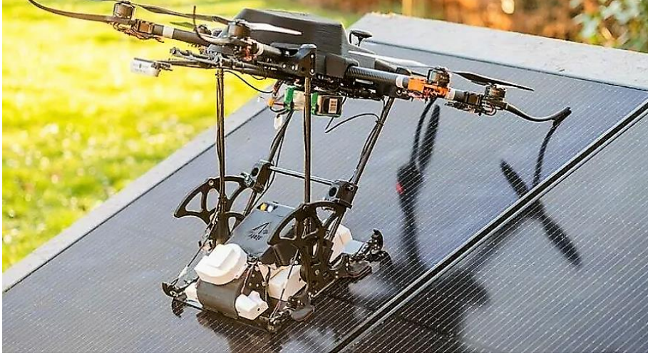
Şekil 4.4. Tozlanmanın drone ile temizlenmesi (URL-26, 2022)
