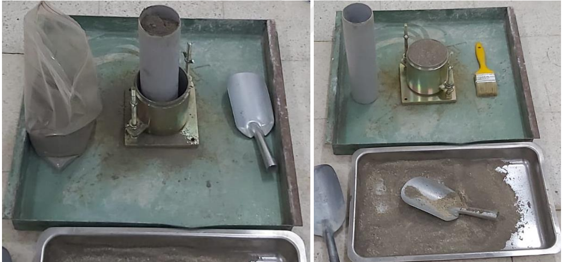
Şekil 3.4. Minimum boşluk oranının bulunması
