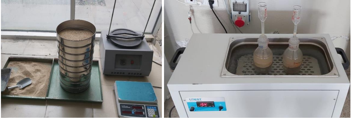
Şekil 3.2. Elek analizi ile kumun dane çapı dağılımının ve piknometre yöntemi ile özgül ağırlık belirlenmesi
