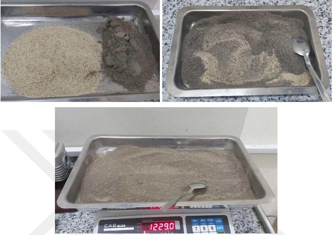
Şekil 3.12. Farklı oranlarda uçucu kül karışımlarının elde edilmesi
