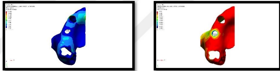
Şekil 29. Model 1’de vertikal kuvvet altında kortikal kemikte oluşan stres dağılımı
