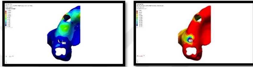
Şekil 103. Model 9'da vertikal kuvvet altında kortikal kemikte oluşan stres dağılımı
