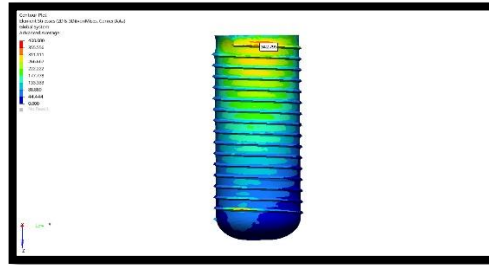
Şekil 89. Model 7’de oblik kuvvet altında implantta oluşan stres dağılımı
