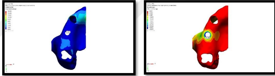
Şekil 56. Model 4'te vertikal kuvvet altında kortikal kemikte oluşan stres dağılımı
