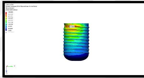
Şekil 71. Model 5'te oblik kuvvet altında implantta oluşan stres dağılımı
