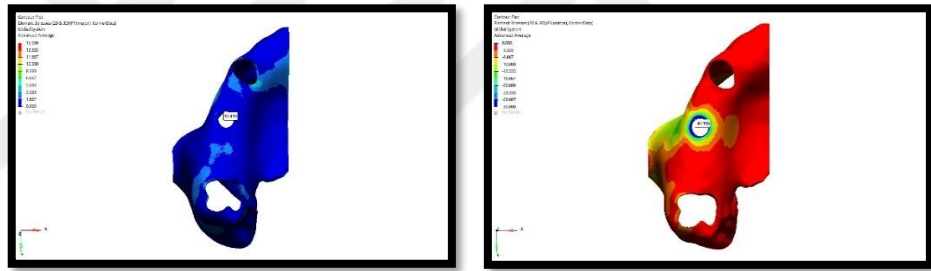
Şekil 47. Model 3'te vertikal kuvvet altında kortikal kemikte oluşan stres dağılımı
