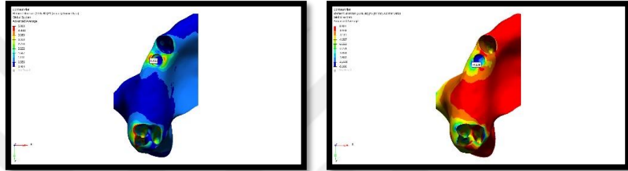
Şekil 88. Model 7’de oblik kuvvet altında trabeküler kemikte oluşan stres dağılımı
