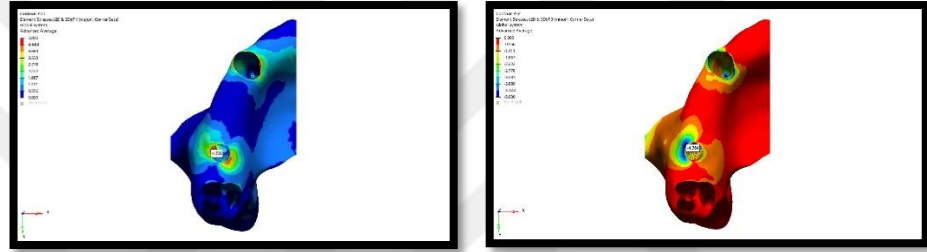
Şekil 79. Model 6'da oblik kuvvet altında trabeküler kemikte oluşan stres dağılımı
