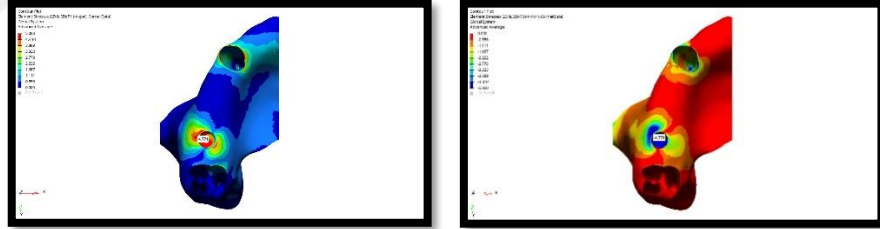
Şekil 98. Model 8'de oblik kuvvet altında trabeküler kemikte oluşan stres dağılımı
