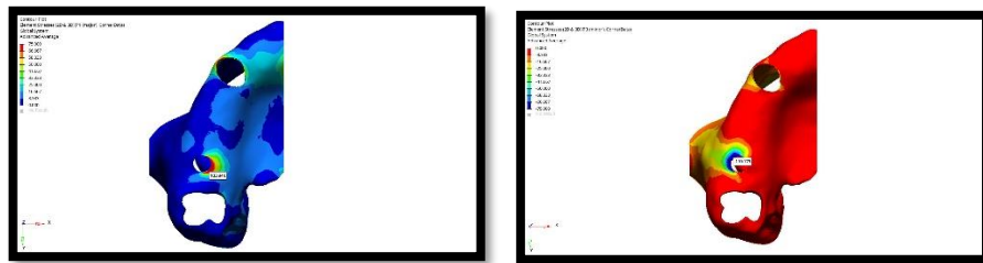
Şekil 107. Model 9’da oblik kuvvet altında kortikal kemikte oluşan stres dağılımı
