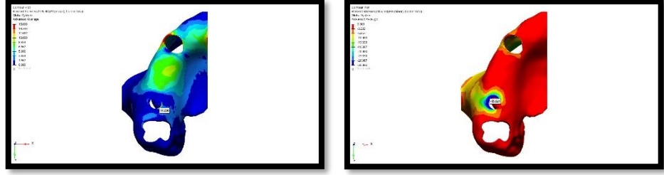
Şekil 93. Model 8’de vertikal kuvvet altında kortikal kemikte oluşan stres dağılımı
