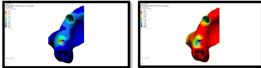
Şekil 104. Model 9'da vertikal kuvvet altında trabeküler kemikte oluşan stres dağılımı
