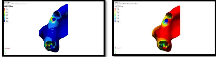
Şekil 84. Model 7’de vertikal kuvvet altında trabeküler kemikte oluşan stres dağılımı
