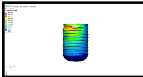
Şekil 99. Model 8'de oblik kuvvet altında implantta oluşan stres dağılımı
