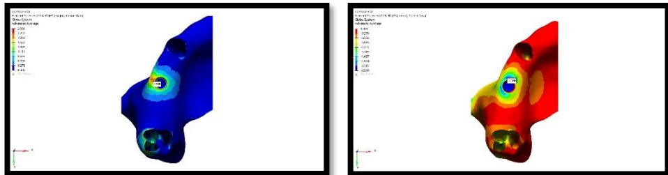
Şekil 48. Model 3'te vertikal kuvvet altında trabeküler kemikte oluşan stres dağılımı
