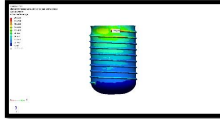
Şekil 95. Model 8’de vertikal kuvvet altında implantta oluşan stres dağılımı
