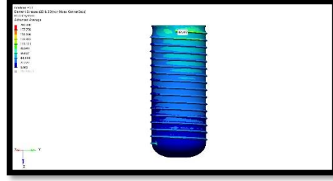
Şekil 31. Model 1 'de vertikal kuvvet altında implantta oluşan stres dağılımı
