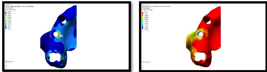
Şekil 51. Model 3'te oblik kuvvet altında kortikal kemikte oluşan stres dağılımı
