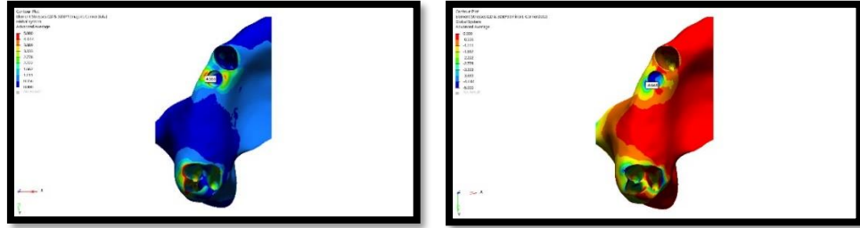
Şekil 43. Model 2’de oblik kuvvet altında trabeküler kemikte oluşan stres dağılımı
