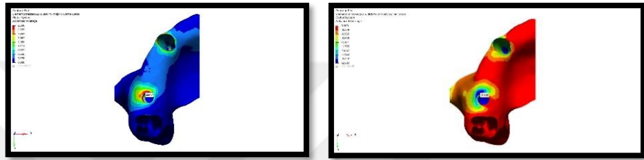
Şekil 94. Model 8’de vertikal kuvvet altında trabeküler kemikte oluşan stres dağılımı
