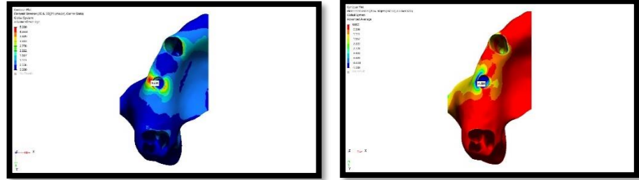
Şekil 61. Model 4'te oblik kuvvet altında trabeküler kemikte oluşan stres dağılımı
