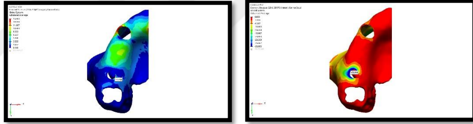
Şekil 65. Model 5'te vertikal kuvvet altında kortikal kemikte oluşan stres dağılımı
