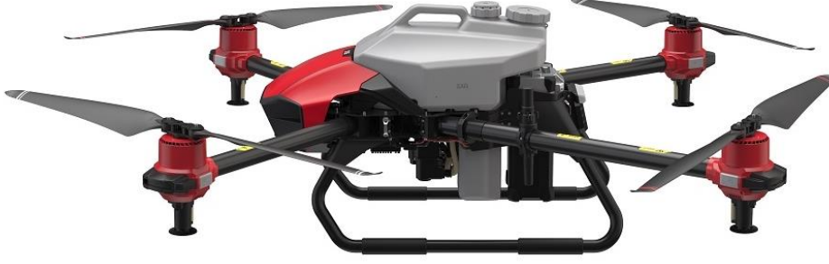
Şekil 3.7. XAG marka XP2020 model insansız hava aracı.
