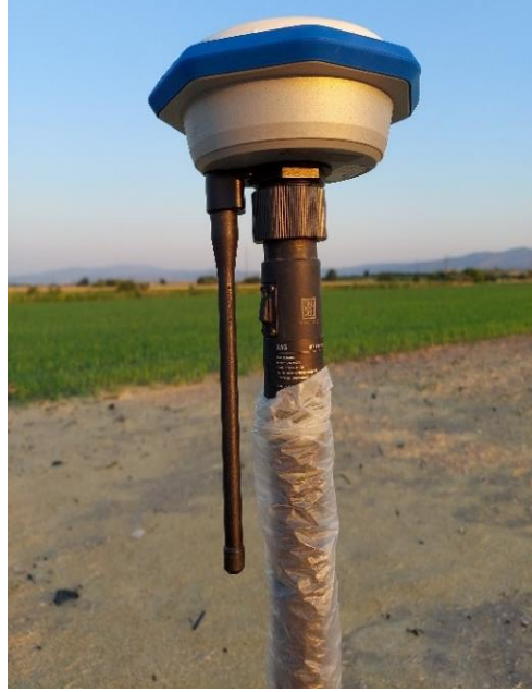
Şekil 3.9 a) RTK Anteninin yakından görünüşü.
