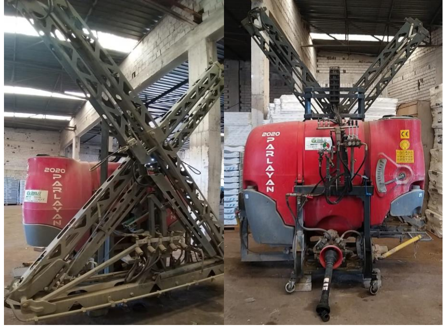
Şekil 3.6. PARLAYAN marka AMAZON model x kollu tarla tipi pülverizatör görüntüsü.
