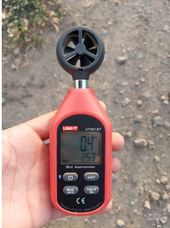
Şekil 3.2. Unit marka Ut-363 BT model mini anemometre.
