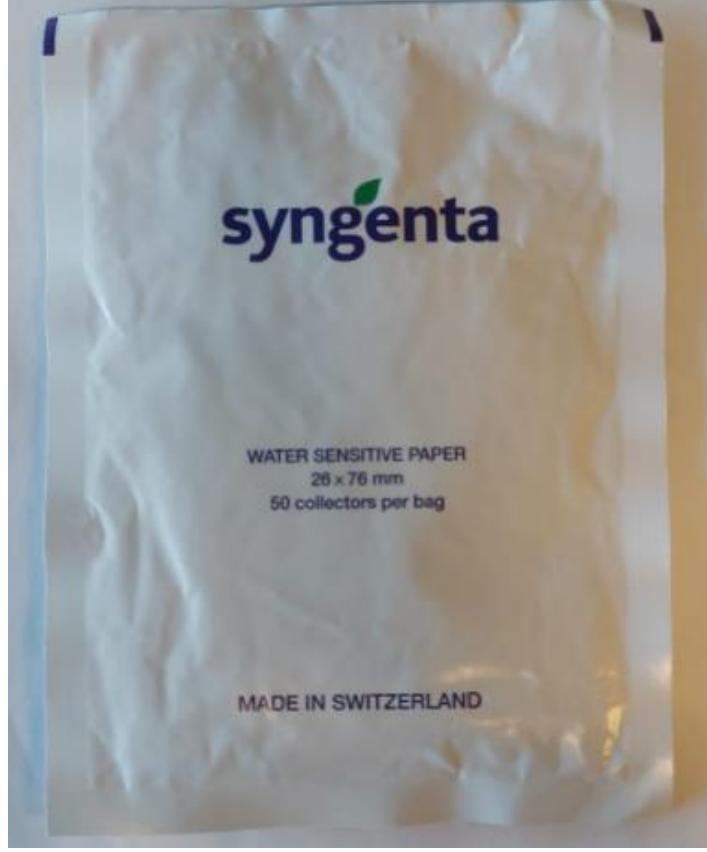
Şekil 3.1. Parametrelerin belirlenmesinde kullanılan suya duyarlı kağıt.
