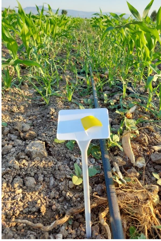
Şekil 3.11. Parsellere yerleştirilen suya duyarlı kağıt düzeneği.
