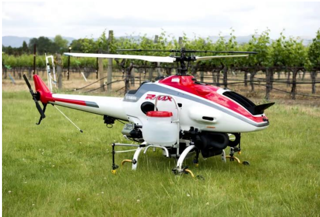
Şekil 1.1. Yamaha Rmax tek rotorlu ilaçlama insansız hava aracı (Anonymous, 2022).
