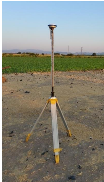
Şekil 3.9 b) RTK Tripodunun yerleştirilmiş görüntüsü.
