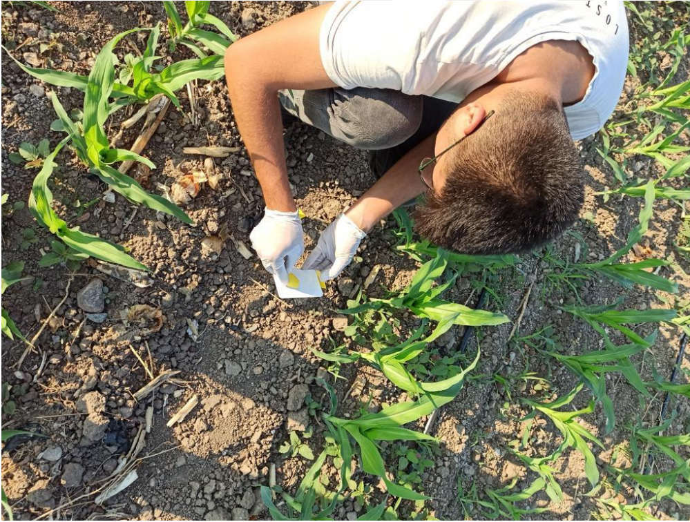
Şekil 3.12. Suya duyarlı kağıtların araziye yerleştirilmesi.
