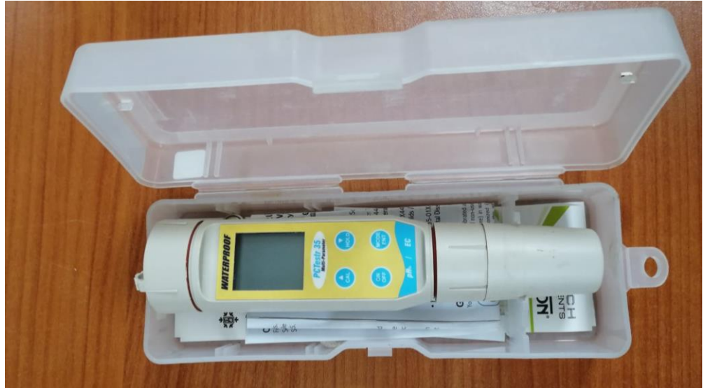
Şekil 3.3. Oakton marka multiparameter tester 35 model pH metre.
