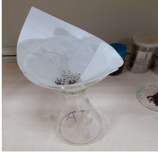
Şekil 3.5. Saf su ile yıkama işlemi
