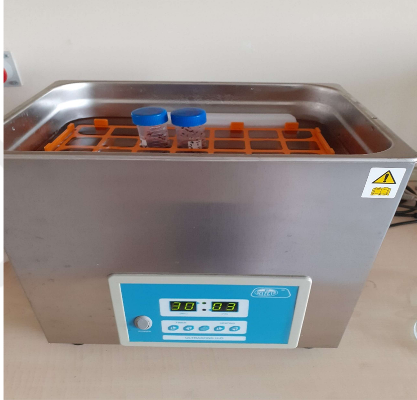
Şekil 3.11. Solvent ekstraksiyonun gerçekleştirildiği sistem
