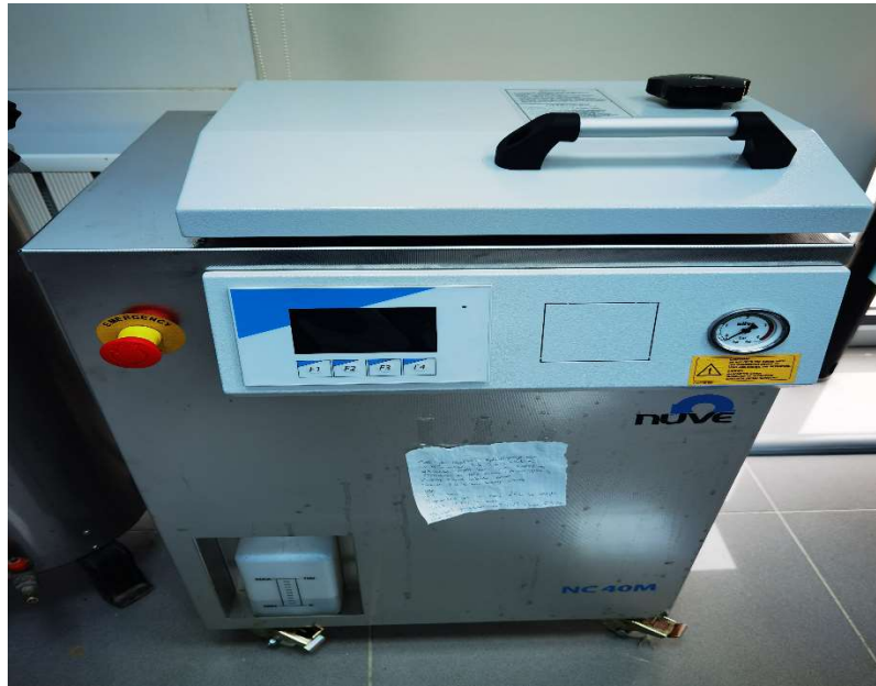
Şekil 2. 8. Besiyerinin sterilizasyonunda kullanılan laboratuvar tipi buharlı otoklav
