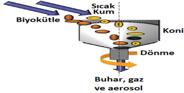
Şekil 1. 7. Dönen koni reaktör şematiği (Verma vd., 2012)
