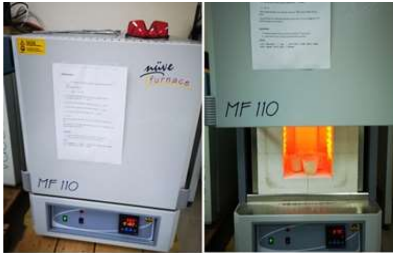
Şekil 2. 12. Kül fırını ve kül içeriğinin belirlenmesi
