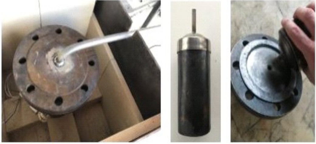
Şekil 2. 5. Piroliz sisteminin reaktör bölmesi ve iç hazne kısmı
