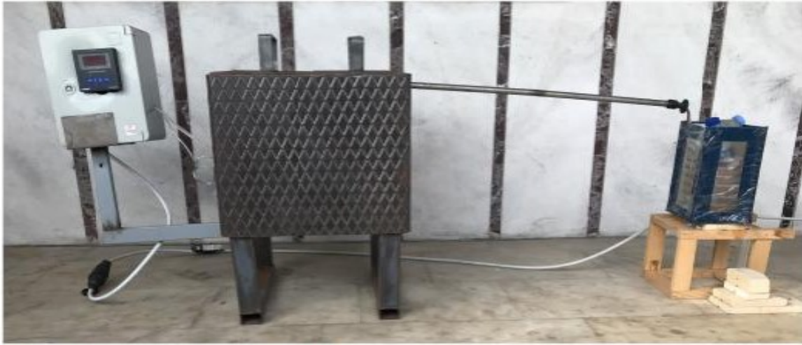
Şekil 2. 2. Piroliz işlemi için geliştirilen sabit yataklı piroliz sisteminin genel görünümü
