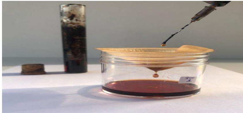
Şekil 2. 19. Piroliz sıvısından odun sirkesi tabakasının ayrıştırılması
