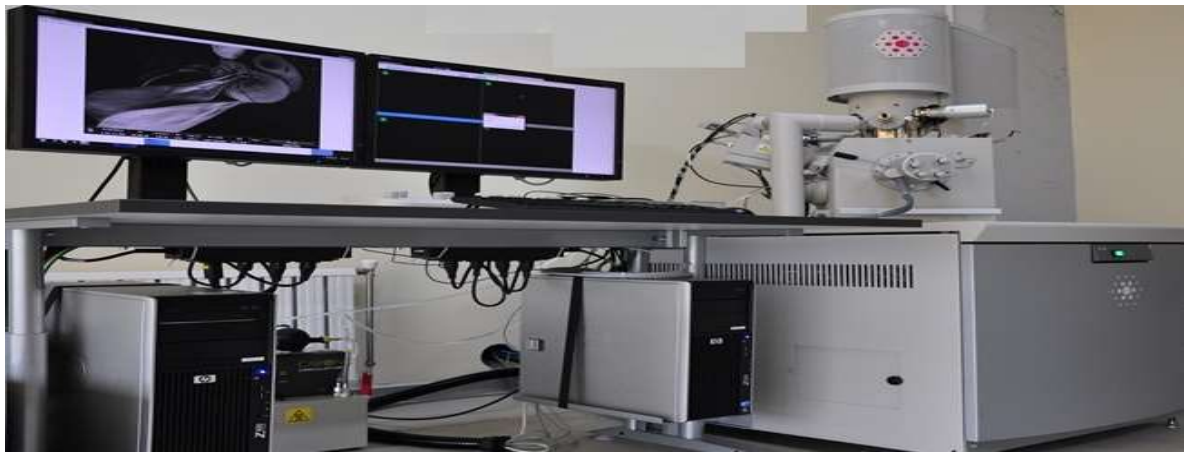
Şekil 2. 16. Biyokömür örneklerinin mikroskopik incelenmesinde kullanılan SEM cihazı
