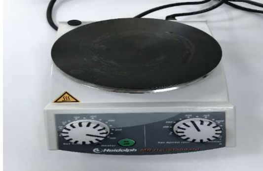
Şekil 2. 10. Besiyerinde homojenizasyonun sağlanmasında kullanılan manyetik karıştırıcı
