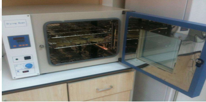
Şekil 2. 11. Nem içeriklerinin ölçülmesinde kullanılan etüv
