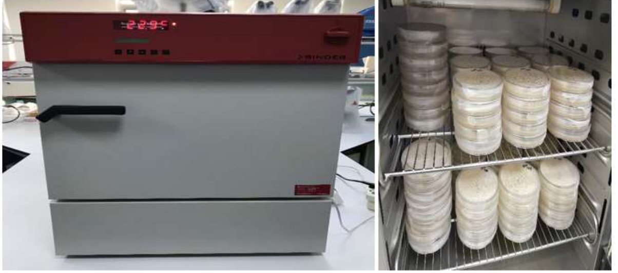
Şekil 2. 9. Fungusların gelişimi için kullanılan inkübatör
