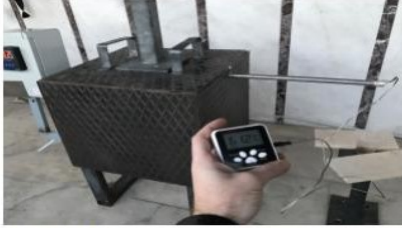
Şekil 2. 4. Gaz çıkış sıcaklığının ölçülmesi
