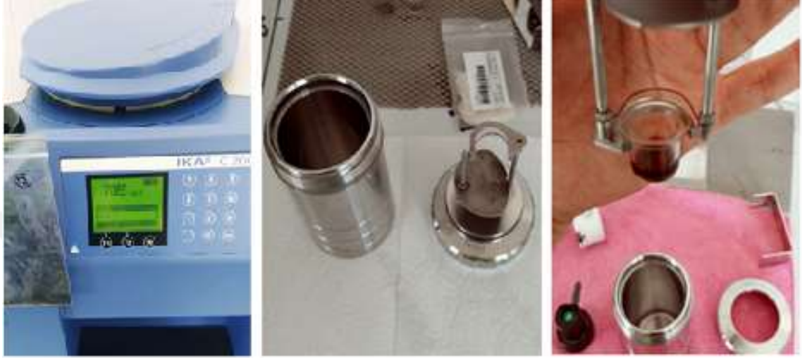
Şekil 2. 13. Isıl değerlerinin saptanmasında kullanılan kalorimetre
