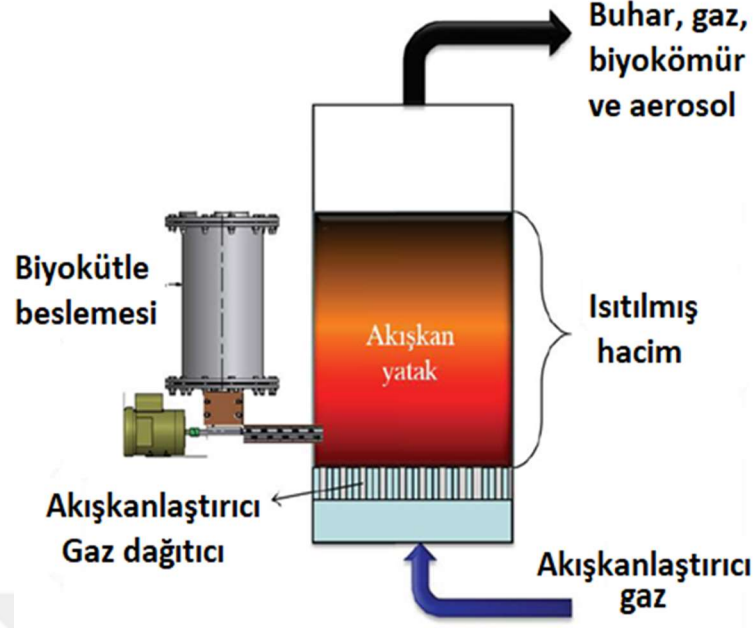
Şekil 1. 4. Kabarcıklı akışkan yataklı reaktör şematifi (Verma vd., 2012)
