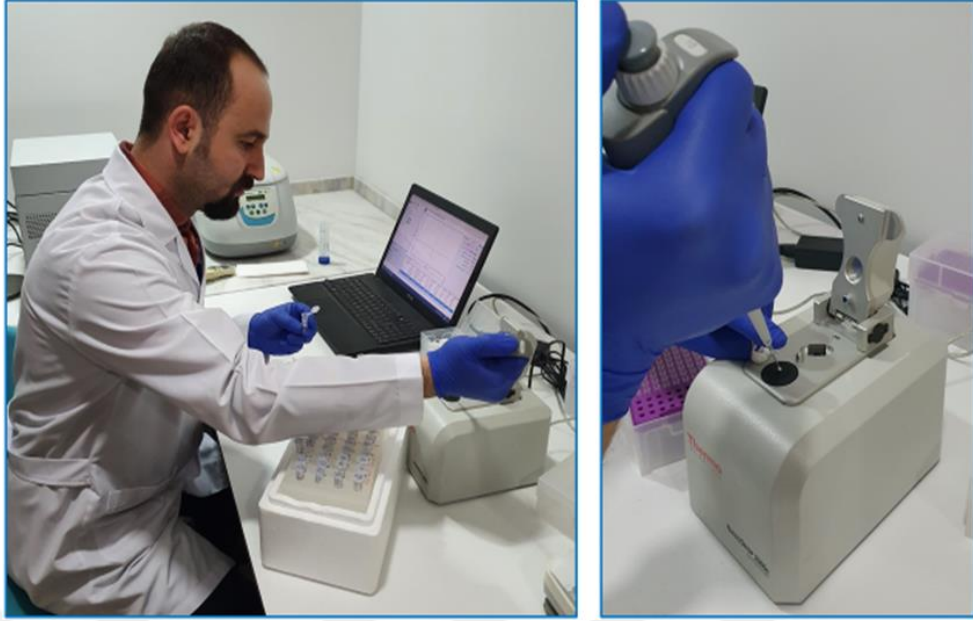
Şekil 20: Spektrofotometrik ölçümler ile RNA konsantrasyonlarının belirlenmesi.
