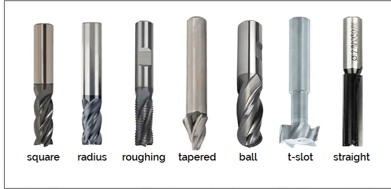
Şekil 1.3. Frezeleme operasyonlarında kullanılan farklı kesici takımlar
