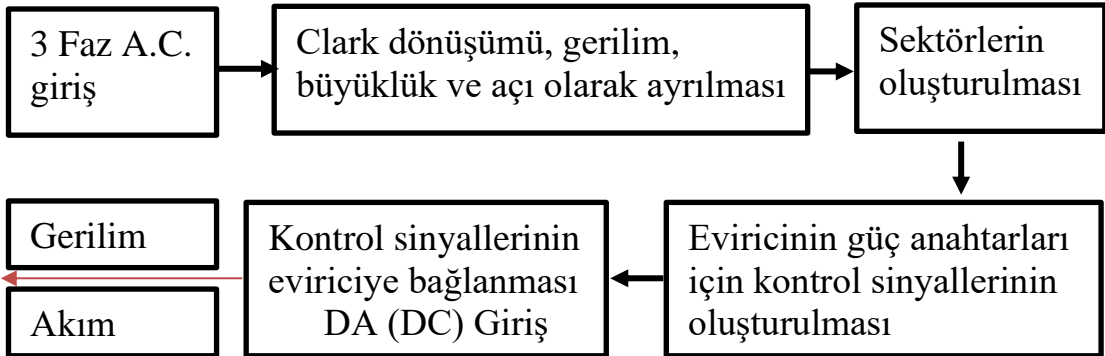
Şekil 4.1 : Uzay vektör darbe genişlik modülasyonu blok diyagramı
