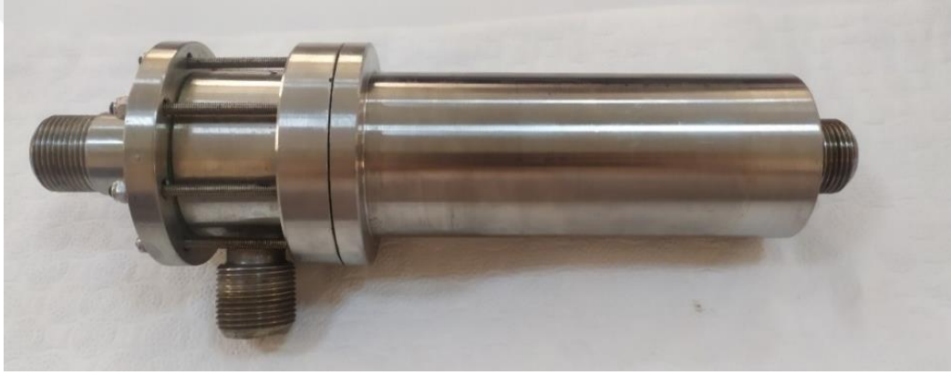
Şekil 3.4. Deneysel sistemde bulunan ejektörün görünümü
