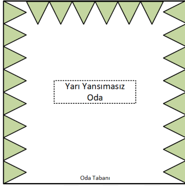
Şekil 2.5 Yarı yansımaz oda şematik gösterim
