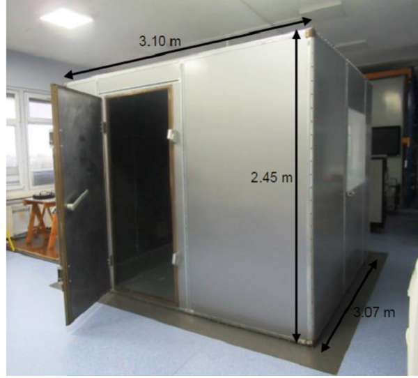
Şekil 4.1 Tam yansımali oda ve boyutları
