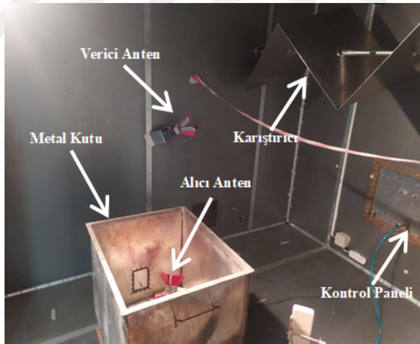
Şekil 4.17 Önerilen teknik ile ekranlama etkinliği ölçüm düzeneği
