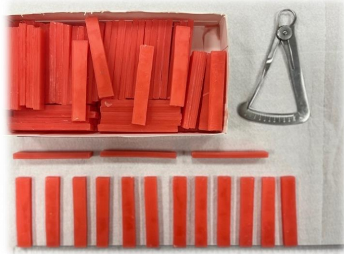
Şekil 3.2. Isı ile Polimerize Olan Deney Örneklerinin Hazırlanmasında Kullanılan Mum Örnekler
