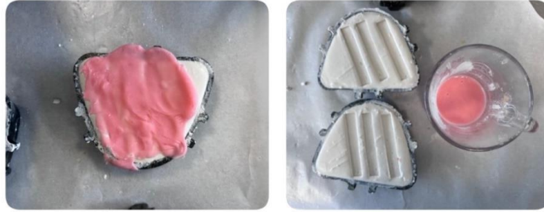
Şekil 3.6. Hamur Kıvamına Gelen Rezinin Negatif Boşluklara Yerleştirilmesi
