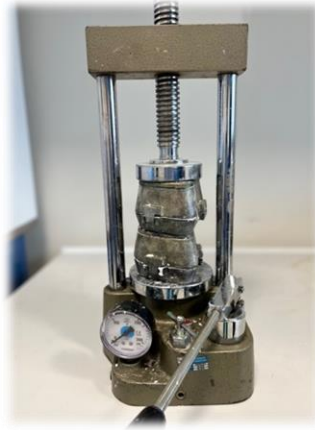
Şekil 3.5. Mum Atımı Öncesi Hazırlanan Mufların Hidrolik Preste Bekletilmesi
