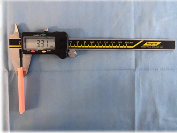
Şekil 3.10. Elde Edilen Örnek Kalınlıklarının Dijital Kumpas ile Kontrol Edilmesi
