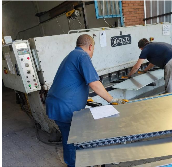
Şekil 3.32. Giyotin Makas ile Yaprak Sac Ebatlanması
