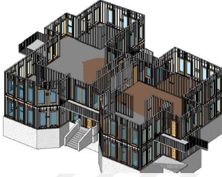
Şekil 3.3. Tasarım Sürecinde Hafif Çelik Yapı Örneği (Abu-Hamd, 2015).
