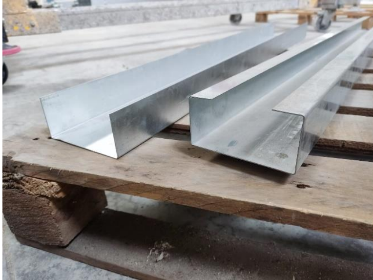
Şekil 3.33. Abgant Pres ile Malzeme Bükümü
