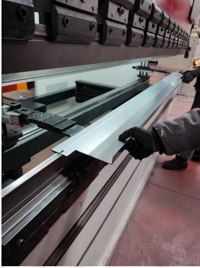
Şekil 3.33. Abgant Pres ile Malzeme Bükümü
