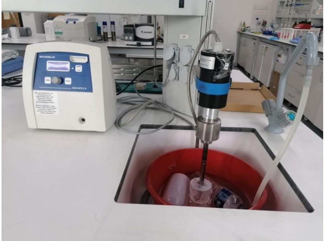
Şekil 5.5 : Ultrasonik prob sonikatörde çözeltinin karışımı.
