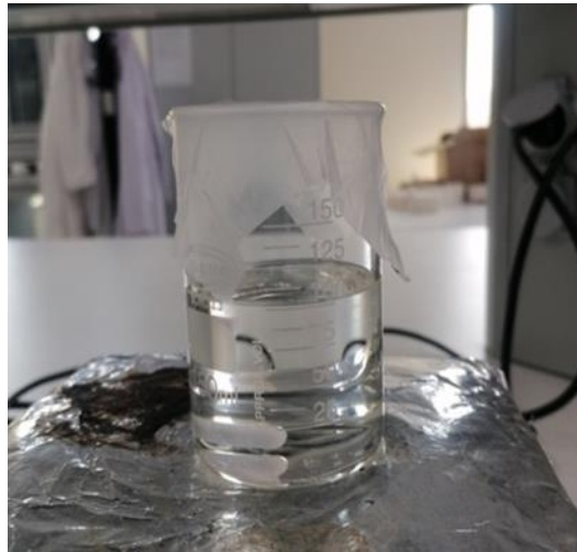
Şekil 5.4 : Manyetik karıştırıcı sonrası PLA'nın görünümü.
