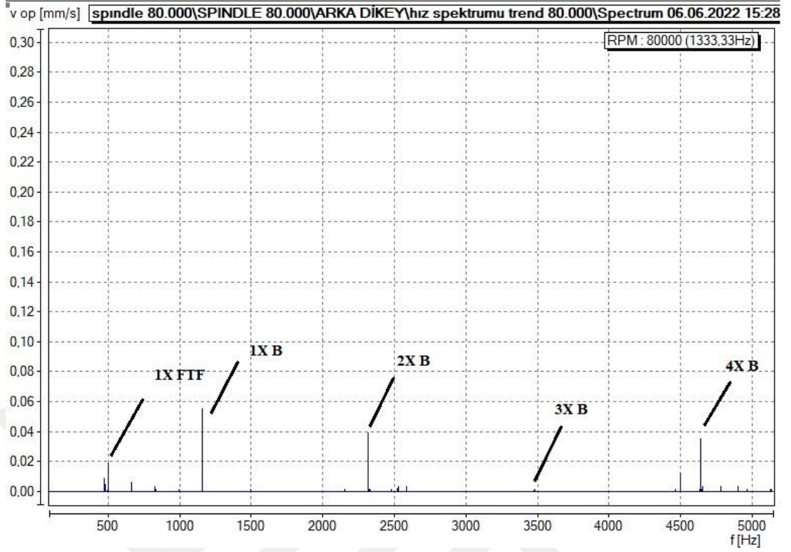
Şekil 13.60. 4A Makara 80.000 RPM iş mili dengesizlik ve arka 71902 FTF arıza teşhisi (06.06.2022).
