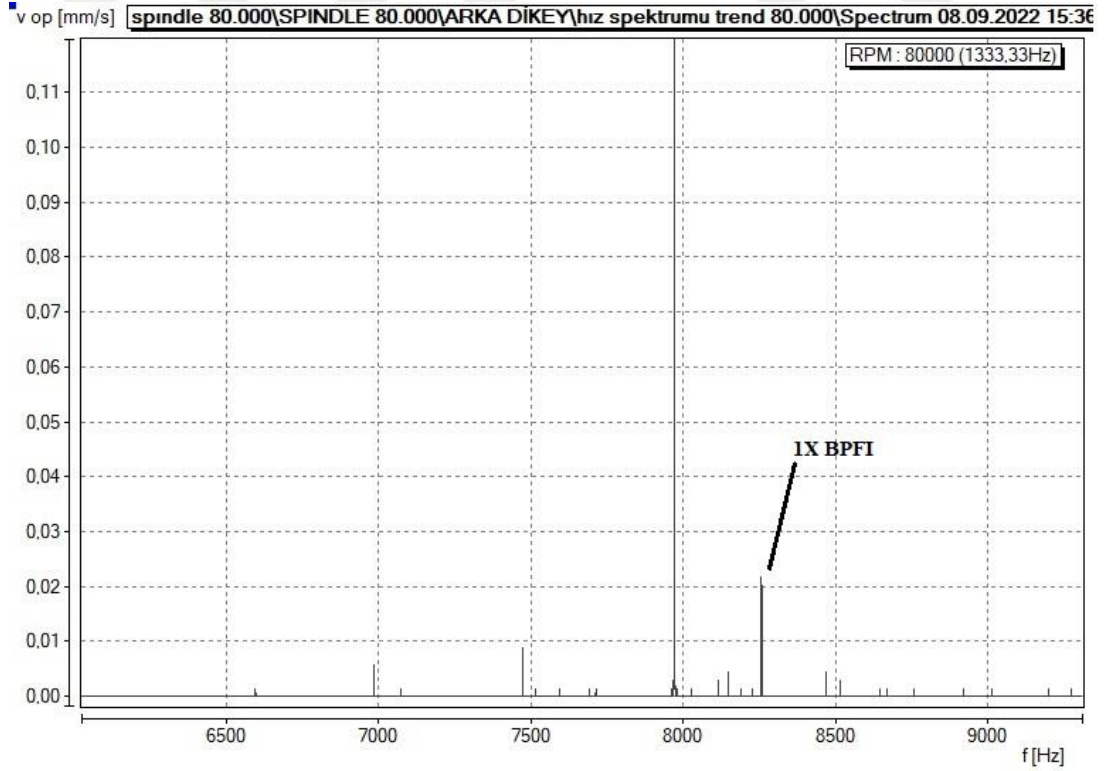
Şekil 13.70. 4A Makara 80.000 RPM iş mili arka 71902 BPFI arıza teşhisi (08.09.2022).
