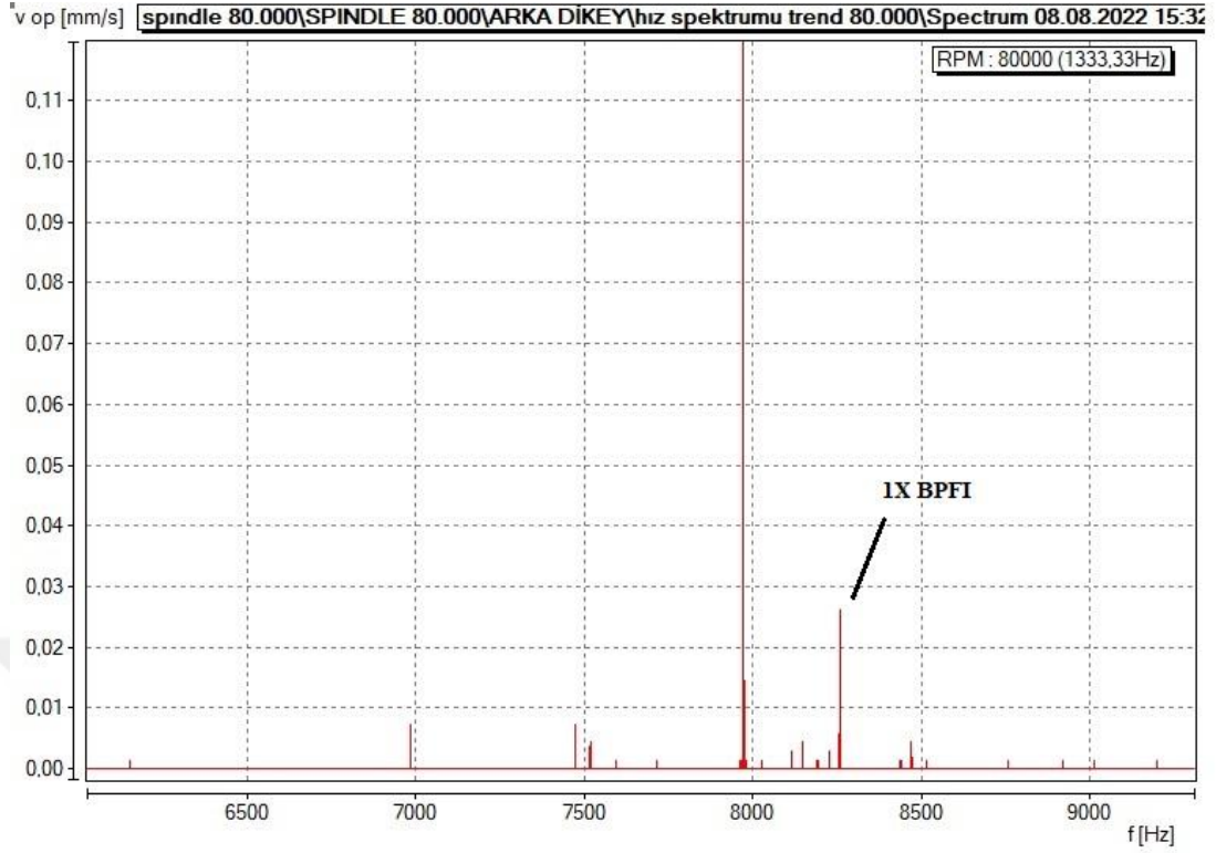
Şekil 13.69. 4A Makara 80.000 RPM iş mili arka 71902 BPFI arıza teşhisi (08.08.2022).
