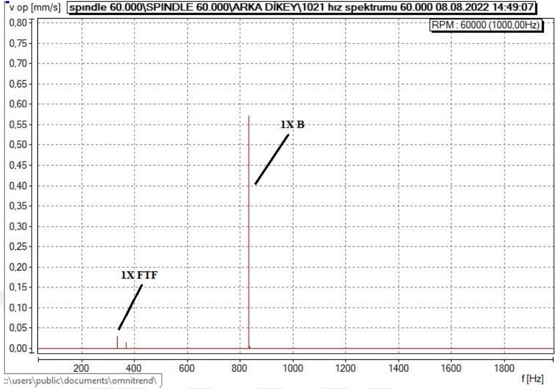
Şekil 13.50. 4B 34.Hat 60.000 RPM arka 7004 FTF arıza teşhisi (08.08.2022).
