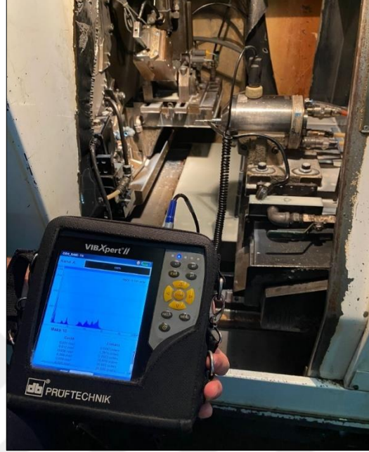
Şekil 13.4. İş mili rulmanı titreşim ölçümü.
