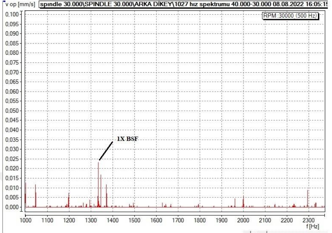
Şekil 13.29. 4B 34.Hat 30.000 RPM iş mili arka 71907 BSF arıza teşhisi (08.08.2022).
