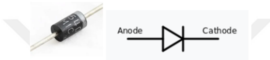
Figure 2.27 : (a) Rectifier diode, (b) Rectifier diode symbol.
