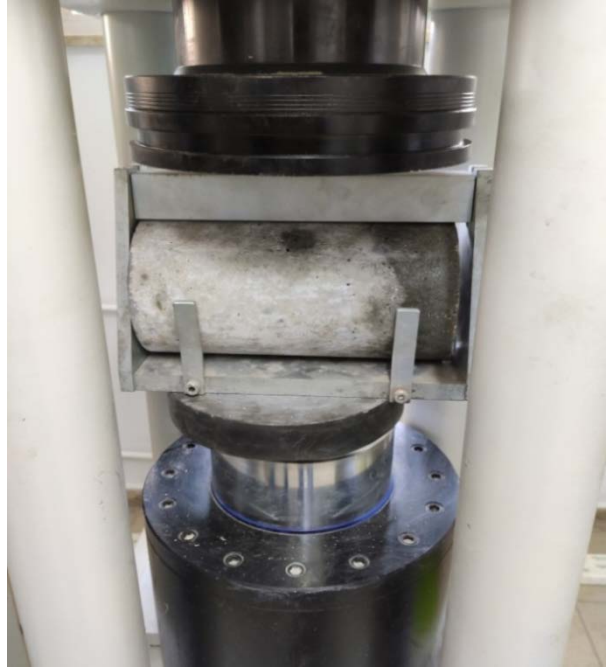
Şekil 3.7. Yarmada çekme deneyi
