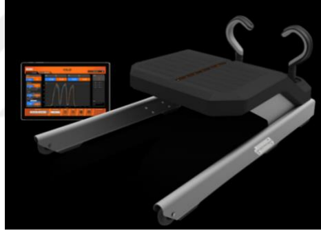
Şekil 3.5. NordBord hamstring ölçüm cihazı
