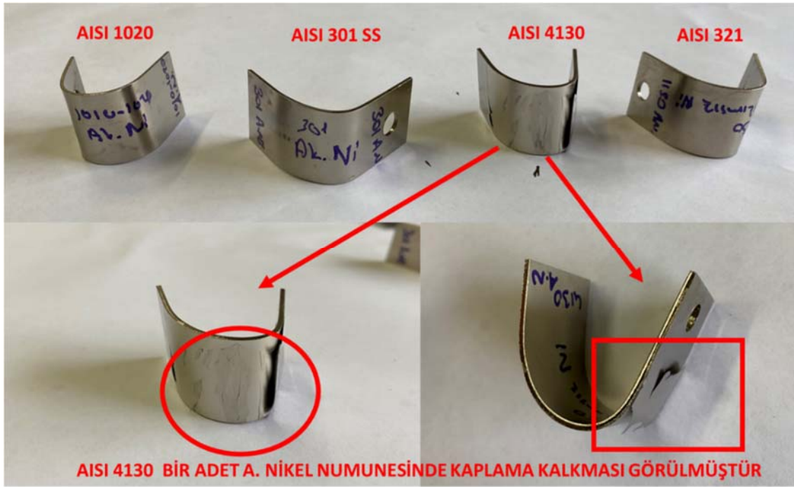
Şekil 4.22. Akımsız Nikel Test Kuponlarının Büküm Sonrası Görüntüleri
