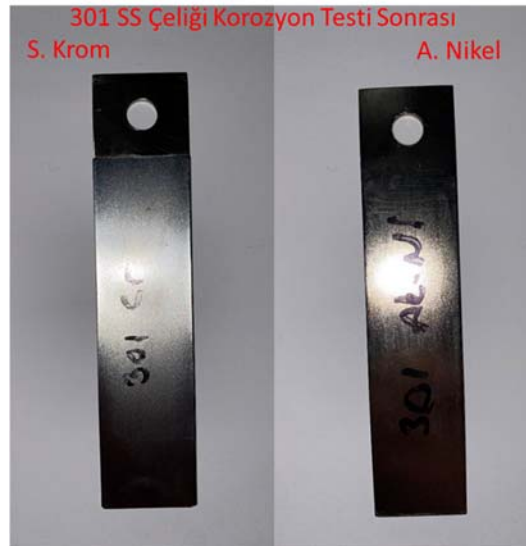
Şekil 4.31. 301 Çeliğ i Korozyon Testi Sonrası Görünüm S. Krom (sol), A. Nikel (Sağ)
