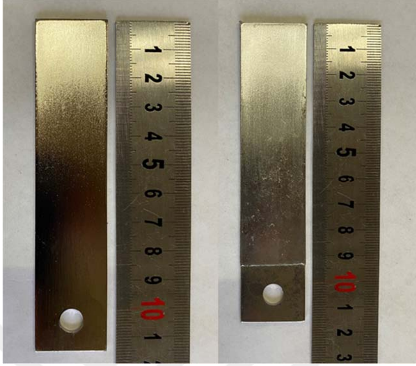
Şekil 4.2. AISI 1020 Çeliğine ait Kuponlar A. Nikel (sol), Sert Krom (sağ)
