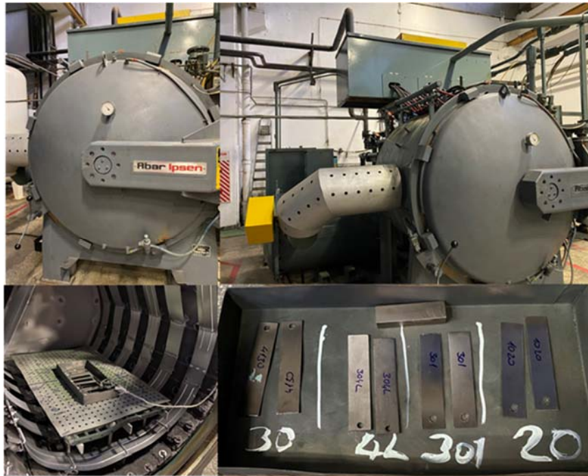
Şekil 3.15. Abar Ipsen HR 34 Vakum Fırını (üstte), Isıtım İşlem Gören Test Kuponları(altta)
