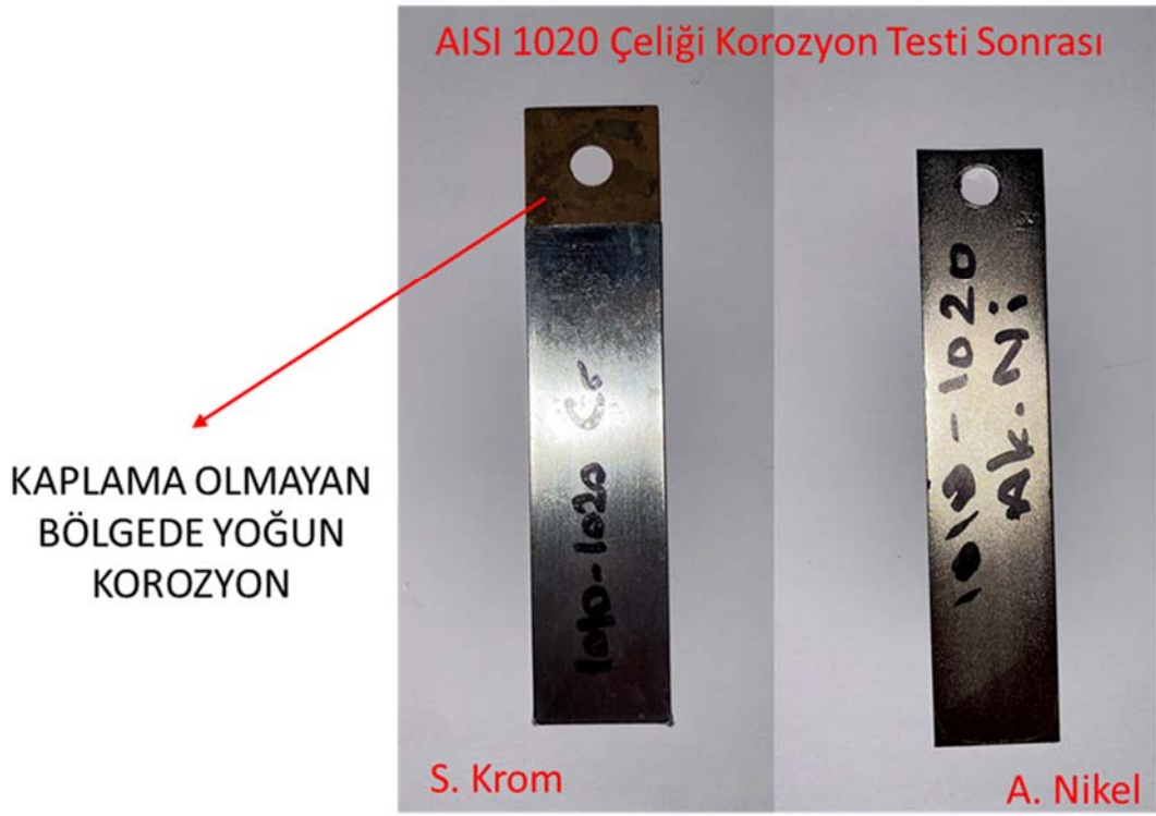
Şekil 4.33. AISI 1020 Çeliği Korozyon Testi Sonrası Görünüm S. Krom (sol), A. Nikel (Sağ)
