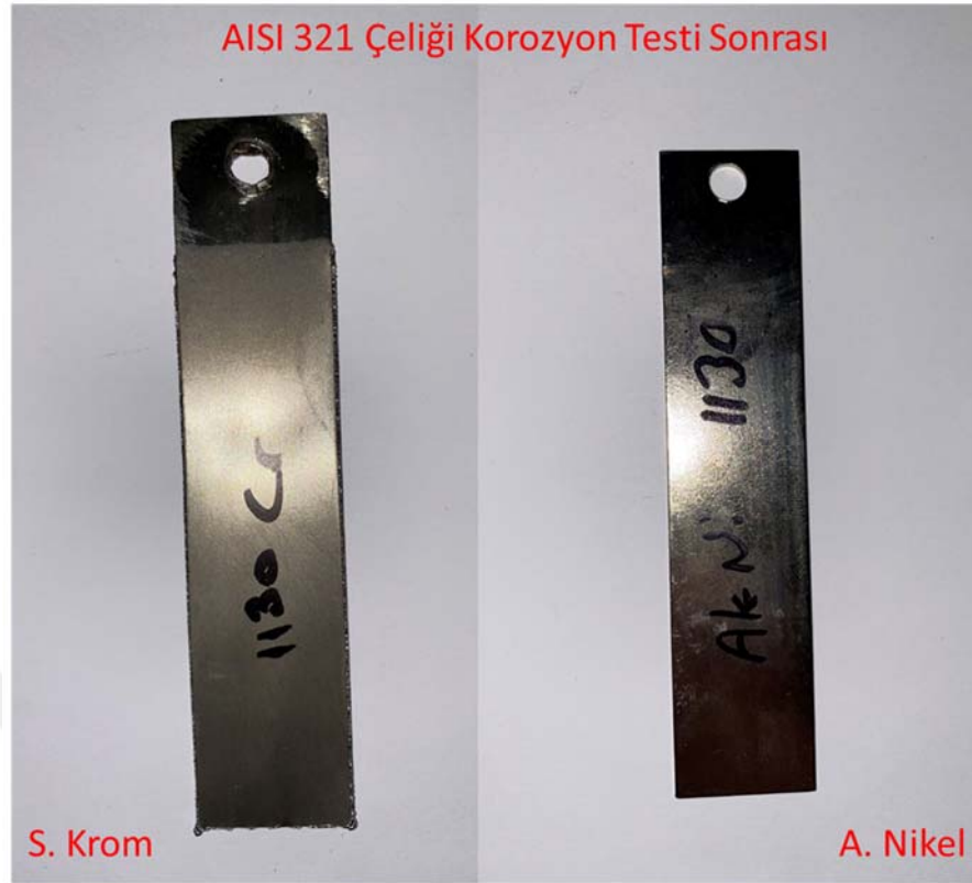
Şekil 4.34. AISI 321 Çeliği Korozyon Testi Sonrası Görünüm S.Krom (sol), A.Nikel (Sağ)
