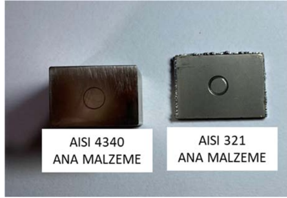
Şekil 4.37. Ana Malzemelerin Aşınma Testi Sonrası Görünümleri
