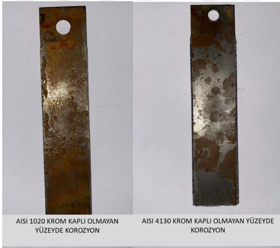
Şekil 4.35. AISI 1020(sol), AISI 4130(sağ) Krom Kaplı Numunelerde Korozyon
