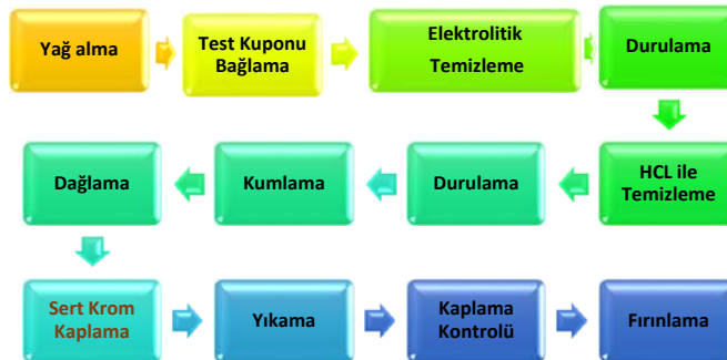
Şekil 3.3 Yüksek Mukavemetli Çeliklere Uygulanan İşlem Adımları
