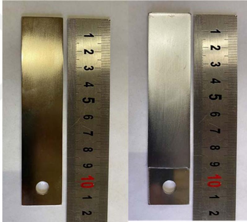
Şekil 4.1. 301 Çeliğine ait kuponlar Akımsız Nikel(Sol), Sert Krom (Sağ)
