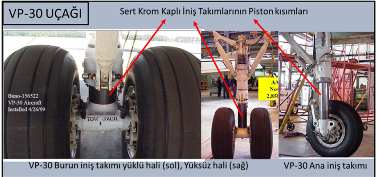
Şekil 2.10. İniş Takımlarında Sert Krom Kaplı Kısımlar (Devereaux, 2004)
