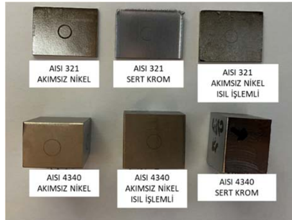
Şekil 4.36. Kaplamaların Aşınma Testi Sonrası Görünümleri
