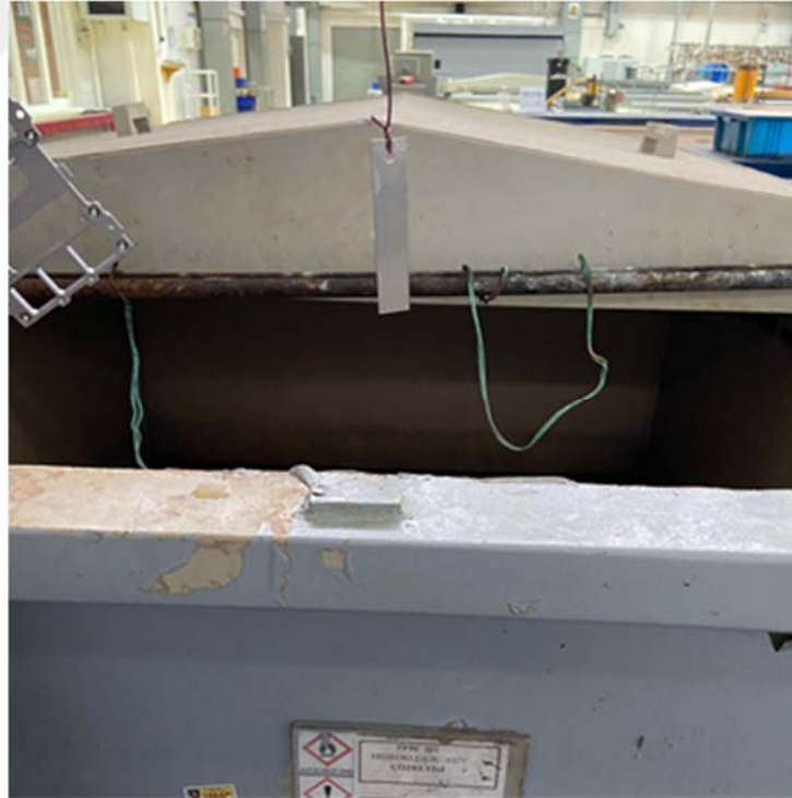
Şekil 3.11. Hidroklorik Asit ile Temizleme İşlemi
