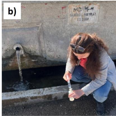
Şekil 3.4 a) Major katyon iyonlarını ve ağır metalleri tayin etmek için örnek alımında kullanılan 100ml'lik şişe ve major anyon iyonlarını tayin etmek için örnek alımında kullanılan 1lt'lik şişe b) Major katyon ve iz elementleri belirlemek için alınan su numunelerine filtreleme işleminin uygulanması c) Katyon ve ağır metal analizi numunelerinde pH'ı 2'ye düşürmek için kullanılan ultra saf nitrik asit ( \text{HNO}_3 )
