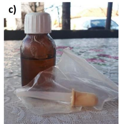
Şekil 3.4 a) Major katyon iyonlarını ve ağır metalleri tayin etmek için örnek alımında kullanılan 100ml'lik şişe ve major anyon iyonlarını tayin etmek için örnek alımında kullanılan 1lt'lik şişe b) Major katyon ve iz elementleri belirlemek için alınan su numunelerine filtreleme işleminin uygulanması c) Katyon ve ağır metal analizi numunelerinde pH'ı 2'ye düşürmek için kullanılan ultra saf nitrik asit ( \text{HNO}_3 )
