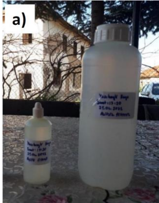
Şekil 3.4 a) Major katyon iyonlarını ve ağır metalleri tayin etmek için örnek alımında kullanılan 100ml'lik şişe ve major anyon iyonlarını tayin etmek için örnek alımında kullanılan 1lt'lik şişe b) Major katyon ve iz elementleri belirlemek için alınan su numunelerine filtreleme işleminin uygulanması c) Katyon ve ağır metal analizi numunelerinde pH'ı 2'ye düşürmek için kullanılan ultra saf nitrik asit ( \text{HNO}_3 )
