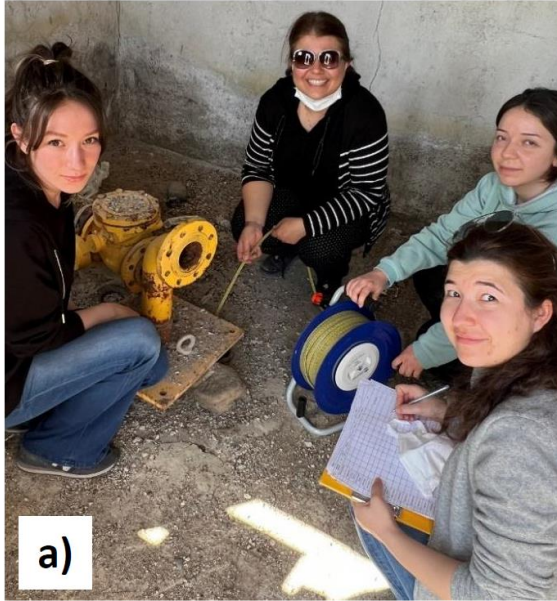
Şekil 3.6 a) Yakup Hasan kuyusunda düdüklü şerit metre ile statik seviye ölçümü alınması b) Yakup Hasan kuyusundan pompa ile su numunesi alınması
