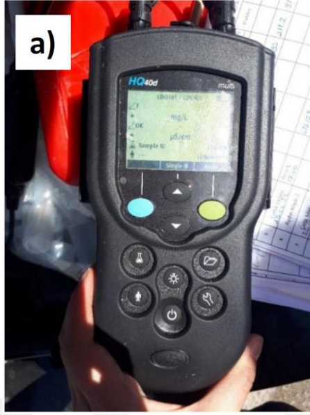
Şekil 3.3 a) Arazide yerinde ölçümde kullanılan HACH HQ-40d marka dijital multimetre cihazı b) Dijital multimetre cihazı ile arazide yerinde ölçüm yapılması (Yazıbeyli kaynak noktası)
