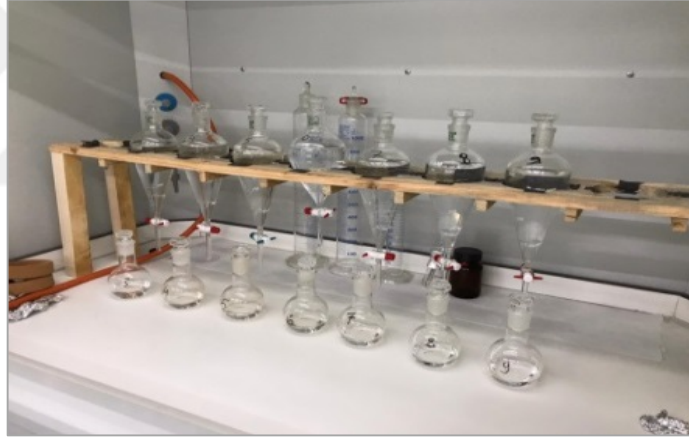
Şekil 3.4. Ambalajlı suların özütleme işlemi
