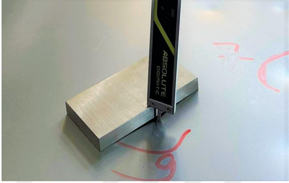
Şekil 7.5 Numunedeki hasar derinliğinin ölçülmesi (Kişisel arşiv, 2022)
