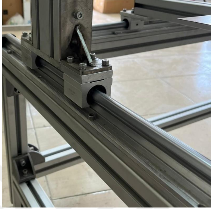
Şekil 6.13 hareket kabiliyeti sağlayan lineer rulman ve raylar (Kişisel arşiv, 2022)
