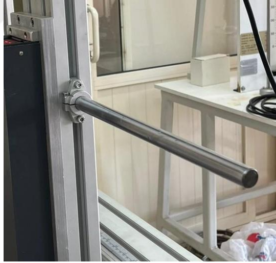
Şekil 6.15 Atış mekanizması yönlendirici kol (Kişisel arşiv, 2022)
