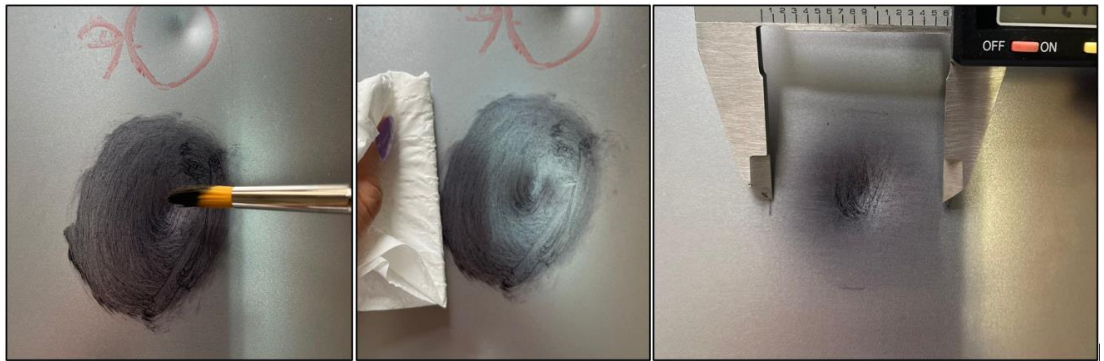
Şekil 7.6 Numunedeki hasar derinliğinin ölçülmesi (Kişisel arşiv, 2022)
