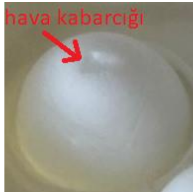
Şekil 6.5 Hava kabarcığına sahip bir buz küresi örneği (Kişisel arşiv, 2022)
