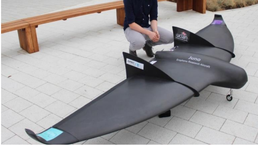
Şekil 1.5. Dış Yüzeyi Grafen Kaplı Hava Aracı(Anonim 4)
