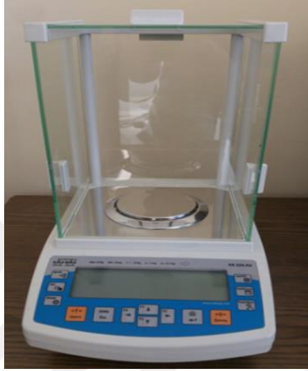
Resim 5.5. Pinyon dişlilerin tartımı için kullanılan analitik terazi
