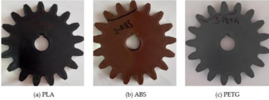
Resim 5.3. Test dişlileri a) PLA b) ABS c) PETG
