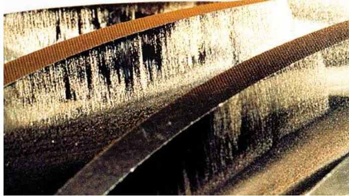
Resim 4.6 Sürtünme aşınmasına örnek (Anonim,2022)
