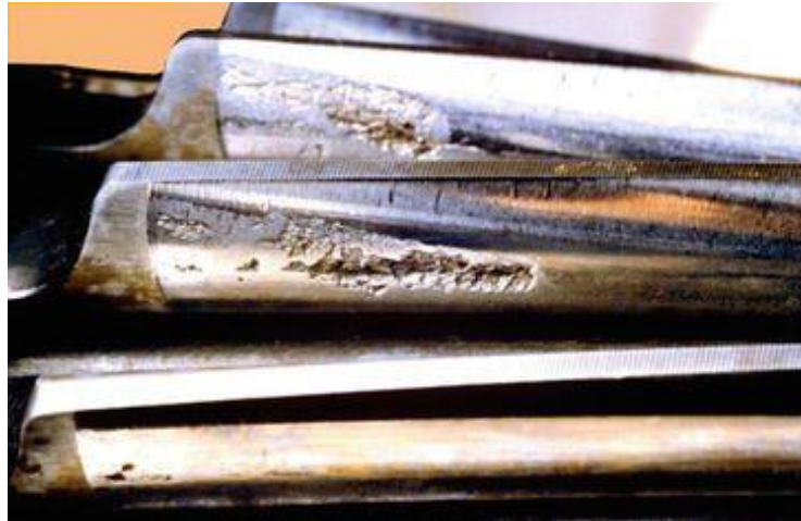
Resim 4.3. Yorulma aşınmasını gösteren bir fotoğraf (Errchello ,2002)
