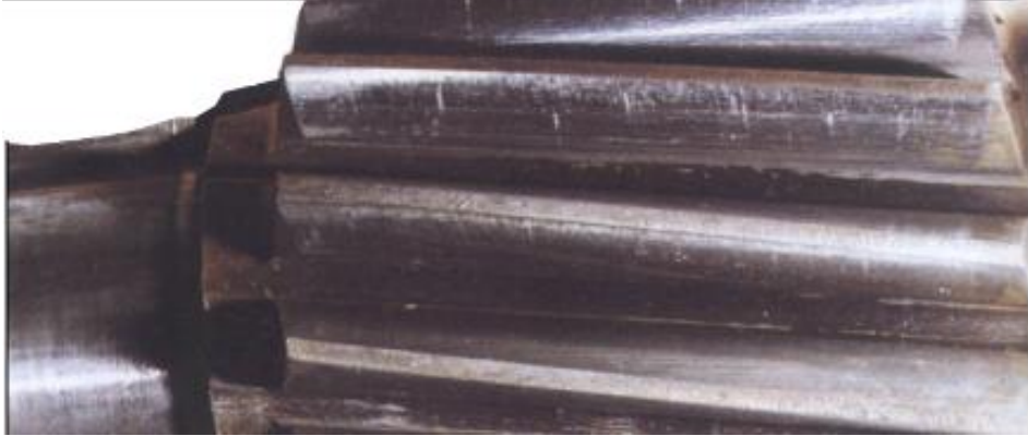
Resim 4.1. Adhesiv aşınmanın gösterimi (Ercello,2002)
