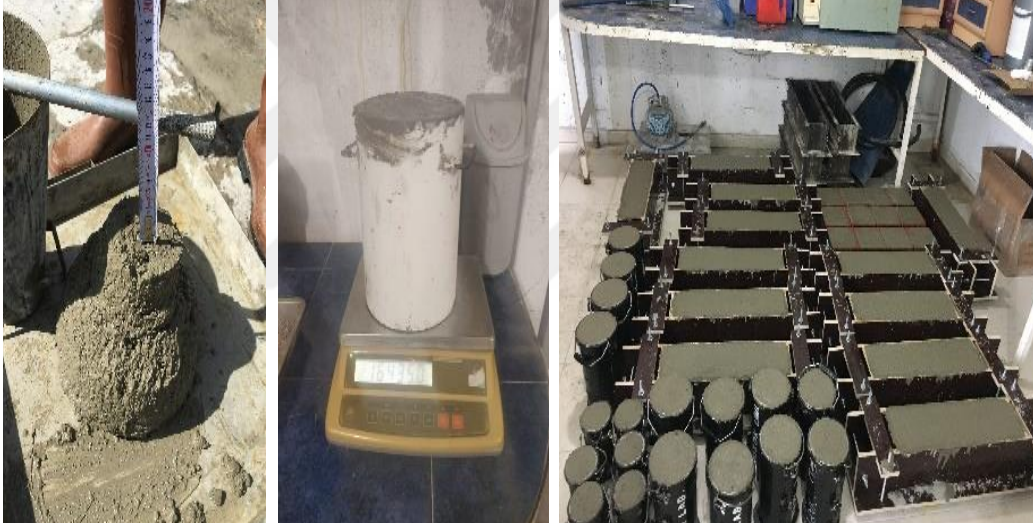
Resim 3.2. Betonun üretimi ve taze betonun deneyleri
