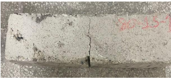
Resim 4.2. Eğilmede çekme deneyi sonrası numunelerin tipik görünümü
