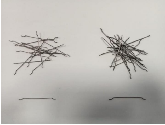
Resim 3.1. Kullanılan çelik teller
