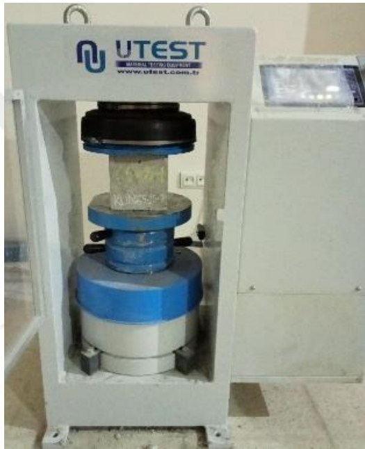
Resim 3.7. Basınç dayanımı deney düzeneği
