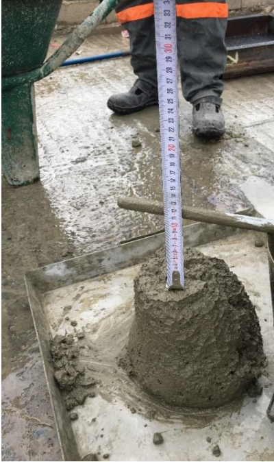
Resim 3.6. İşlenebilme deneyine ait görsel
