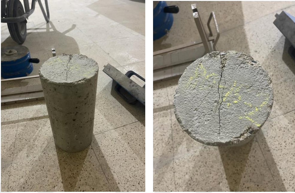
Resim 4.1. Yarmada çekme deneyi sonrası numunelerin tipik görünümü
