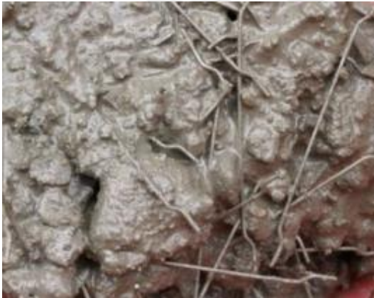
Resim 2.1. Taze Beton İçerisinde Çelik Tellerin Dağılımı
