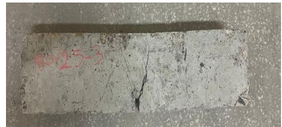
Resim 4.2. Eğilmede çekme deneyi sonrası numunelerin tipik görünümü
