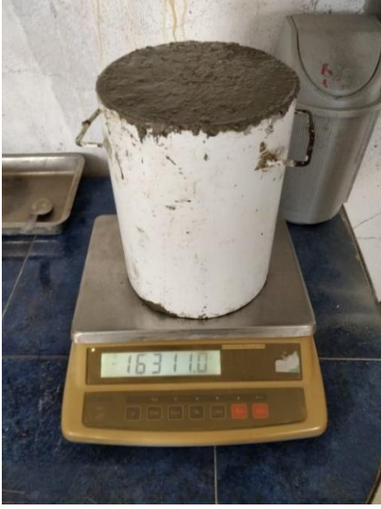
Resim 3.5. Taze birim ağırlık deneyine ait görsel
