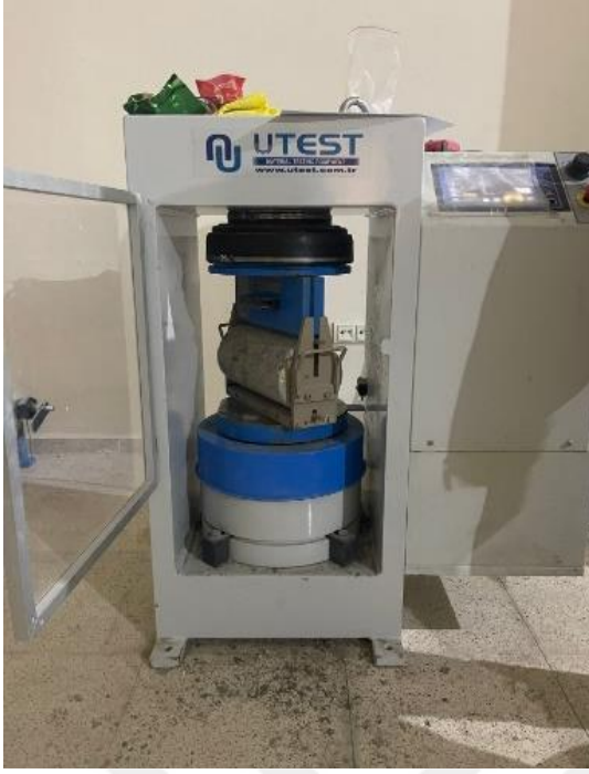
Resim 3.8. Yarmada çekme dayanımı deney düzeneği
