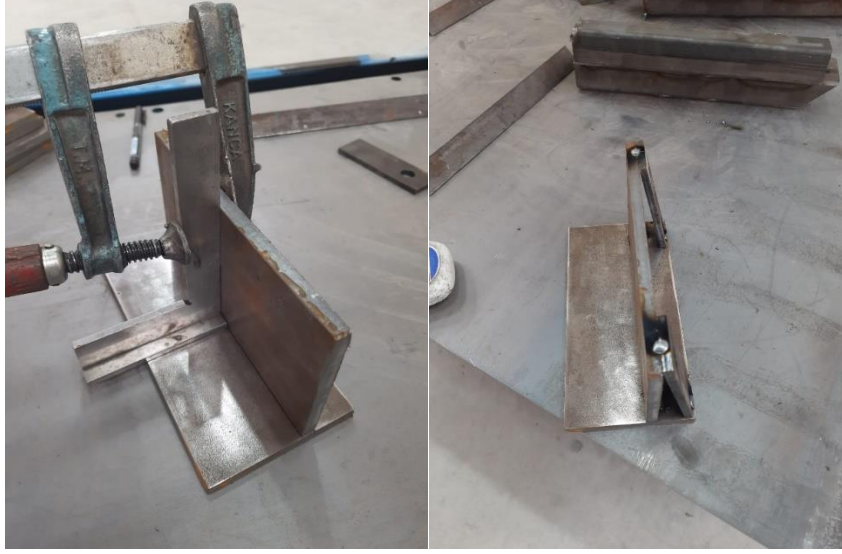
Şekil 4.10 Test plakalarına destek plakaların çatım kaynağının yapılması
