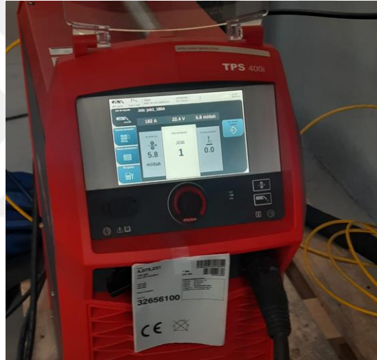
Şekil 4.9 Robotik kaynak makinesine belirlenen parametrelerin girilmesi
