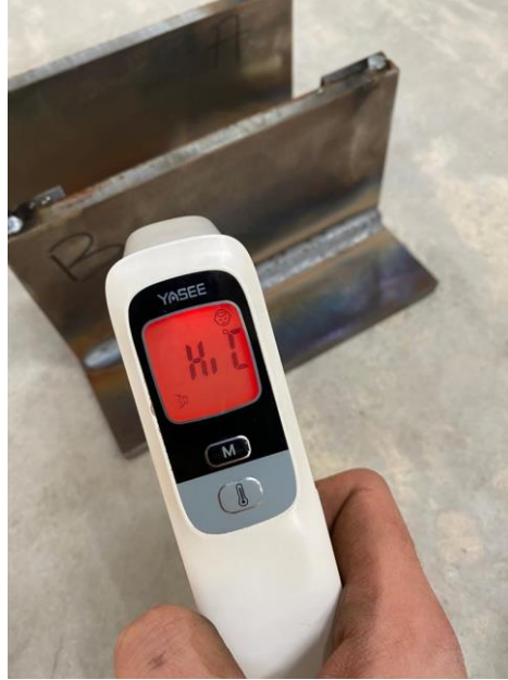
Şekil 4.13 Pasolar arası geçiş sıcaklığı uygun olmayan plaka
