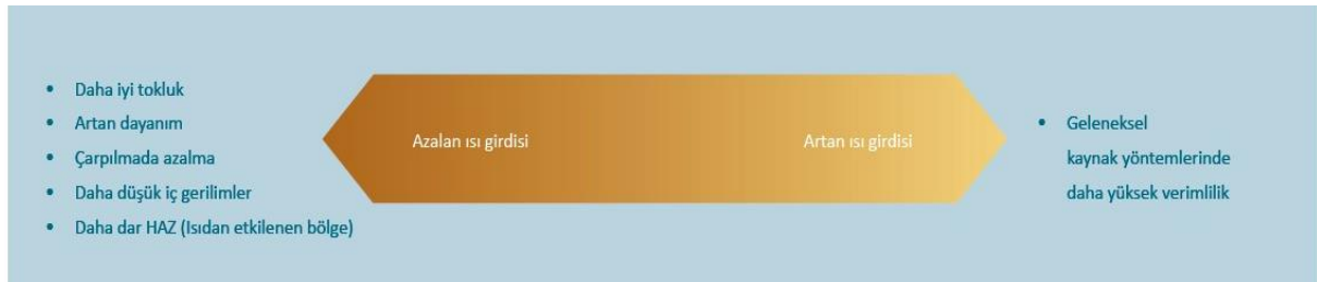
Şekil 3.20 Isı girdisi faktörünün kaynaklı bir bağlantıya olan genel etkisi [28]
