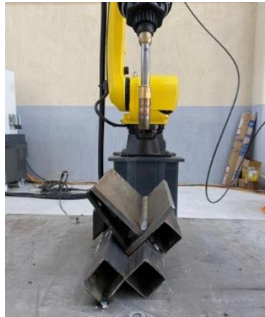
Şekil 4.7 köşe kaynağı yapılacak numune düzeneği
