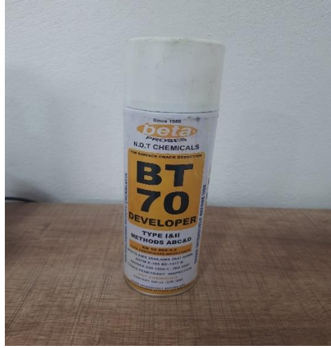
Şekil 5.5 BT 70 developer sprey uygulaması
