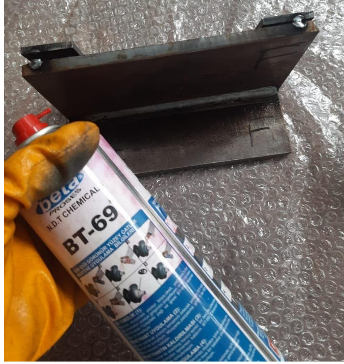
Şekil 5.2 BT-69 cleaner sprej ile malzeme yüzeyinin temizlenmesi
