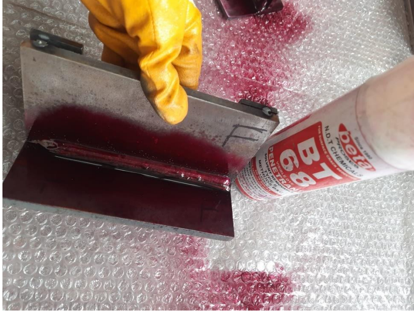
Şekil 5.4 Penetrant spreynin uygulanması
