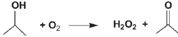
Şekil 1.5 : Sekonder alkol oksidasyonu tarafından hidrojen peroksit sentezi (Campos-Martin ve diğ., 2006)
