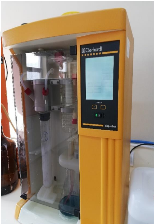
Şekil 2. Protein analizinde kullanılan distilasyon cihazı
