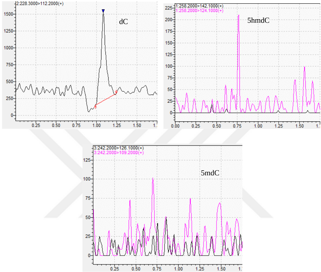
Şekil 36: dC, 5hmdC ve 5mdC için DNA kalibrasyonunda yürütülen kör numune (blank)'ye ait kromatogramlar
