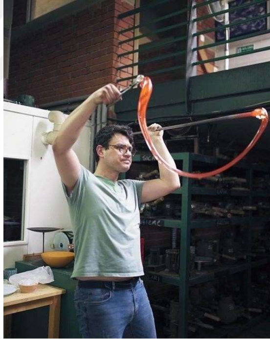
Şekil 3.11. Tek Pipoyla Çubuk Çekme İşlemi
