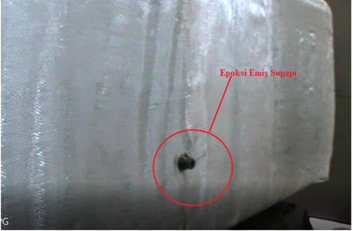
řekil 1.20: Epoksi emiř supabı takılmıř blok 6rneęi.
