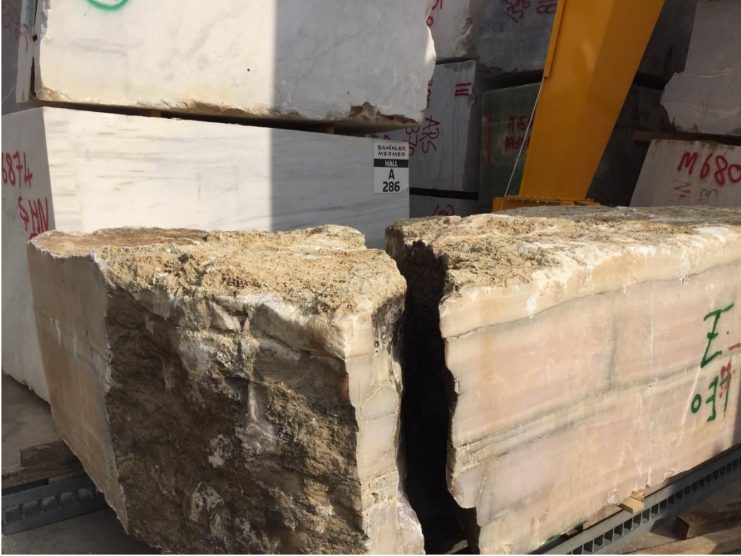
Şekil 1.10: Maden sahasından kırık olarak gelen blok.
