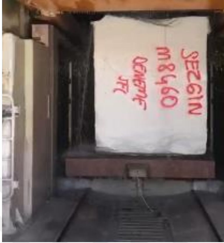
Şekil 3.8: Katrakta kesimi yapılan blok.
