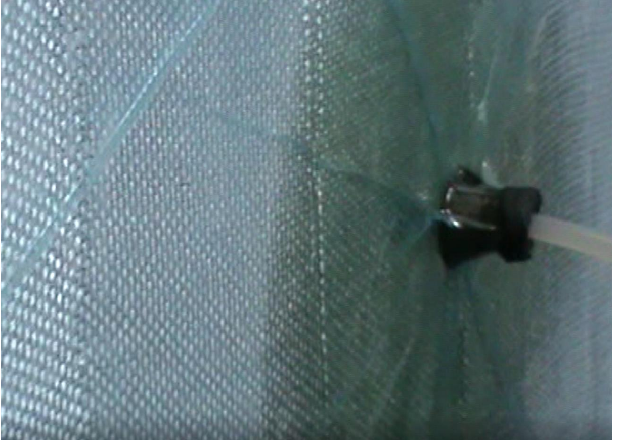
Şekil 1.31: Epoksinin ilk yayılma görüntüsü.
