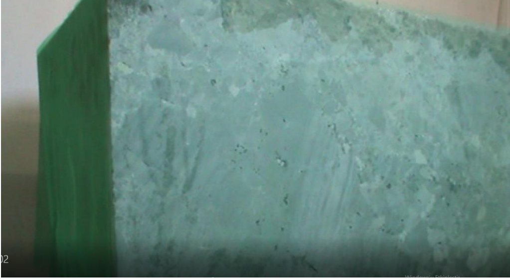
Şekil 1.14: Dört tarafı yayılma filesi ile kaplanmış blok örneği.
