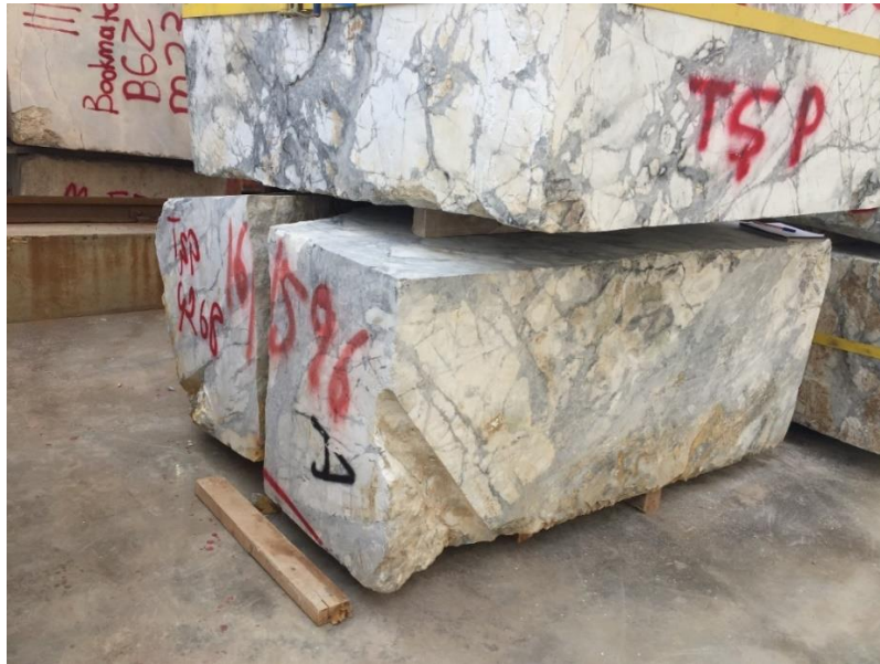
Şekil 1.6: İstifleme alanında taşınma esnasında kırılan blok örneği.
