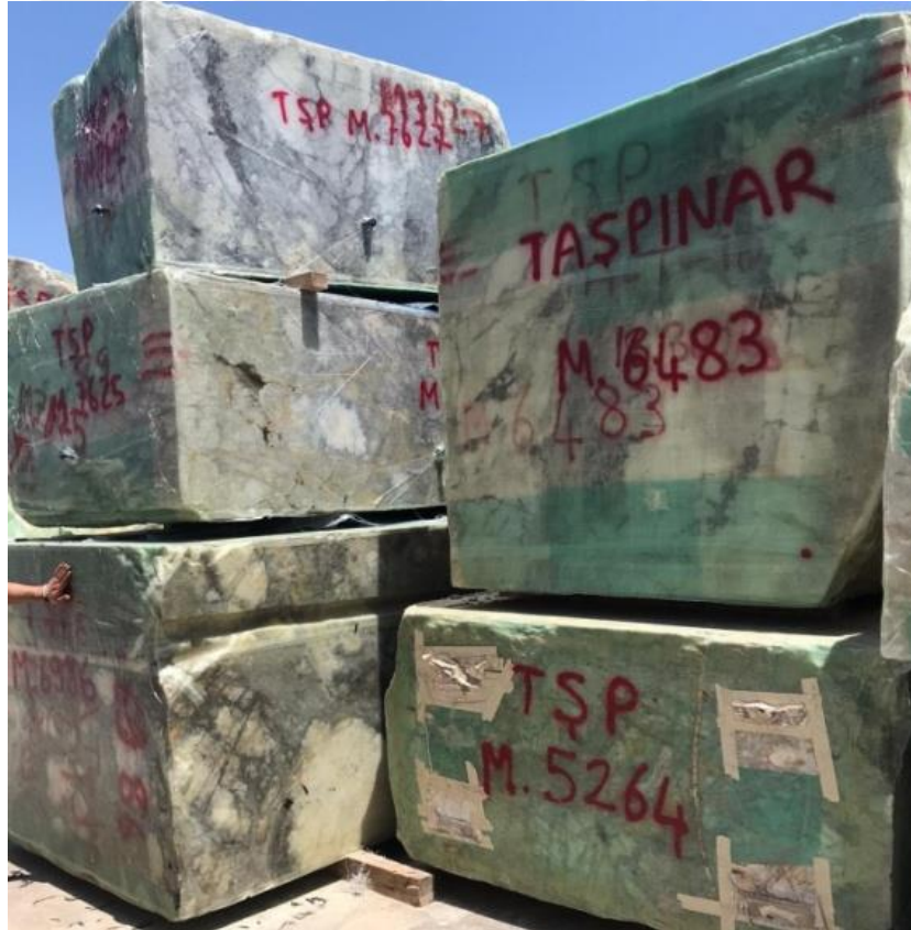
Şekil 3.7: Bohçalanmış ve epoksilenmiş blok.
