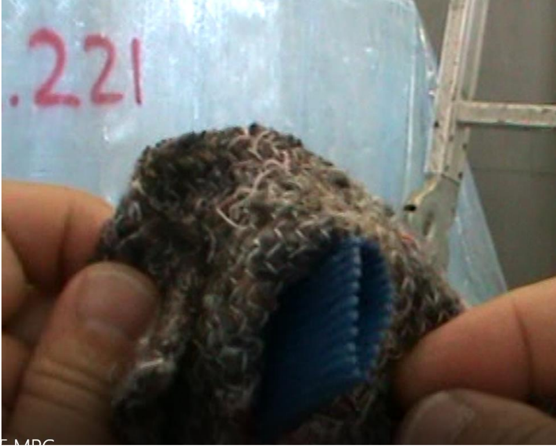
Şekil 1.19: Supabın emiş esnasında tıkanmasını engelleyen file detay örneği.
