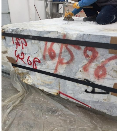
Şekil 1.9: Spanc ile Birleştirilen Kırık Blok.
