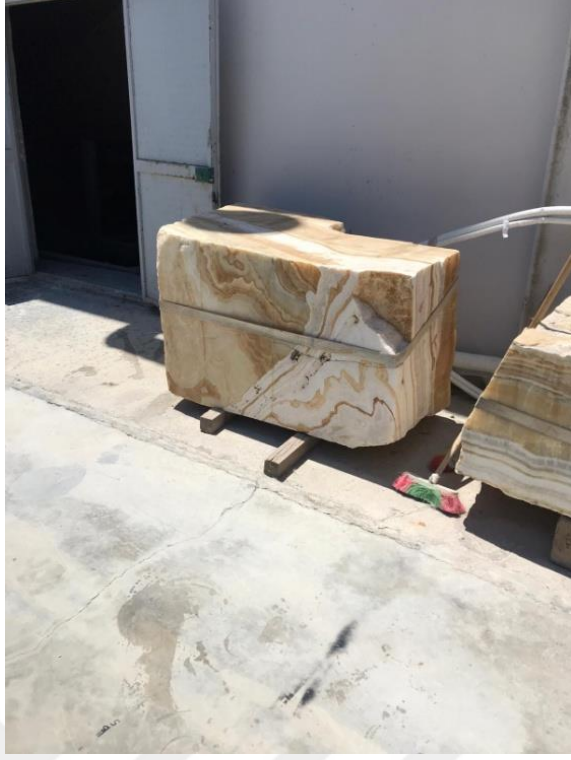
Şekil 3.2: Çatlaklı blok mermer örneđi.
