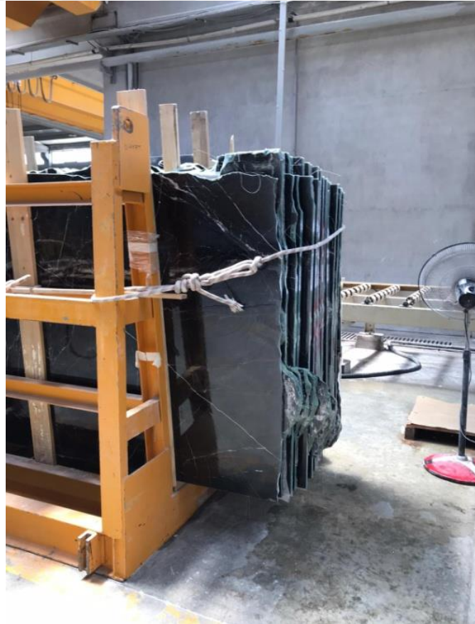
Şekil 3.13: Filelenmiş, epoksilenmiş, parlatılmış levha teslim hazır levha.
