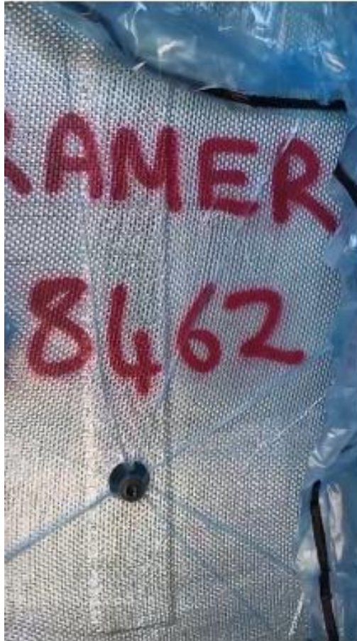
Şekil 3.5: Bohçalama ve vakumlama yapılan blok.
