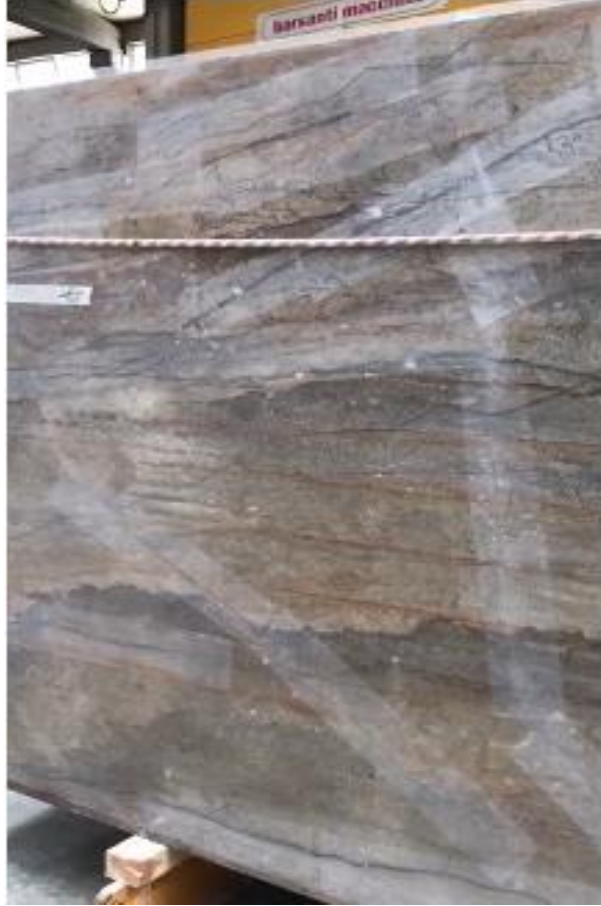
Şekil 3.11: Bu tez kapsamında kullanılan fileleme ve epoksileme işlemi bitmiş levha.
