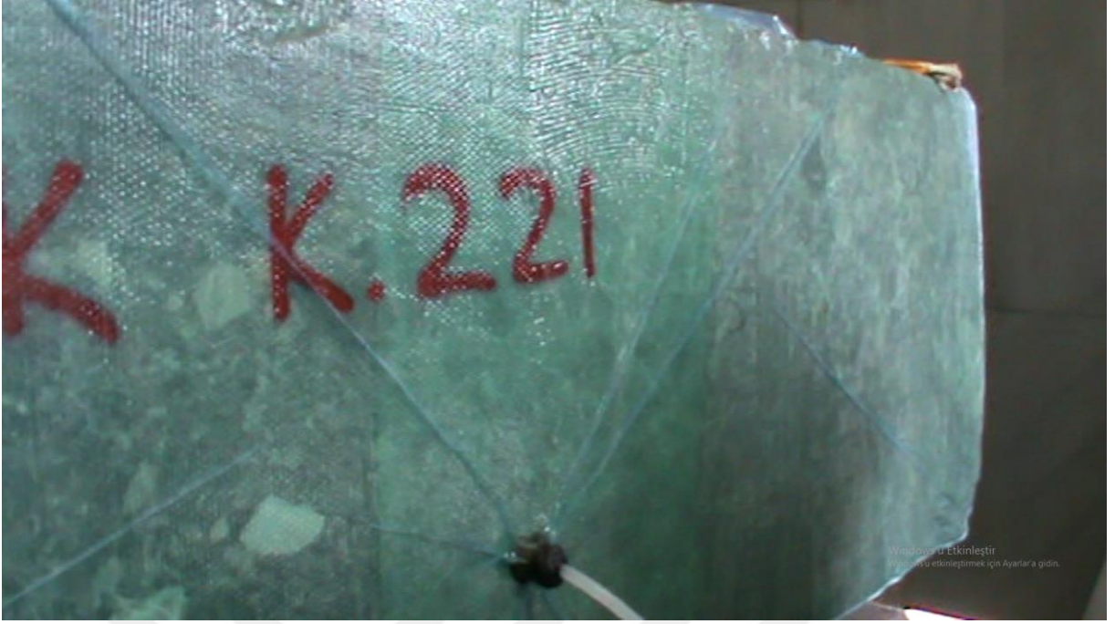
Şekil 1.32: Bloğun tamamının epoksi ile kaplanmış hali.
