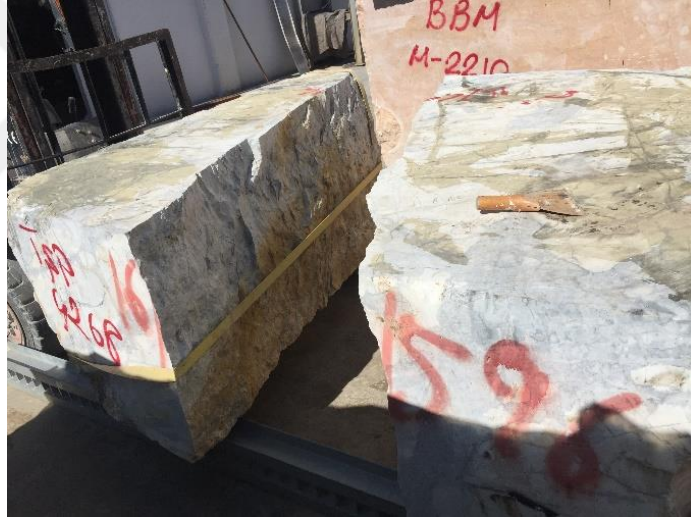
Şekil 1.8: İş makinası ile birbirine yaklaştırılan blok.
