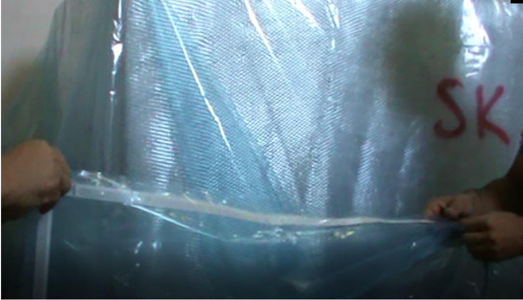
Şekil 1.22: Çift taraflı bant uygulaması yapılan naylonlama süreci.
