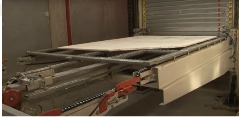
Şekil 1.41: Epoksili levhanın kurutma fırınına giriş anı.
