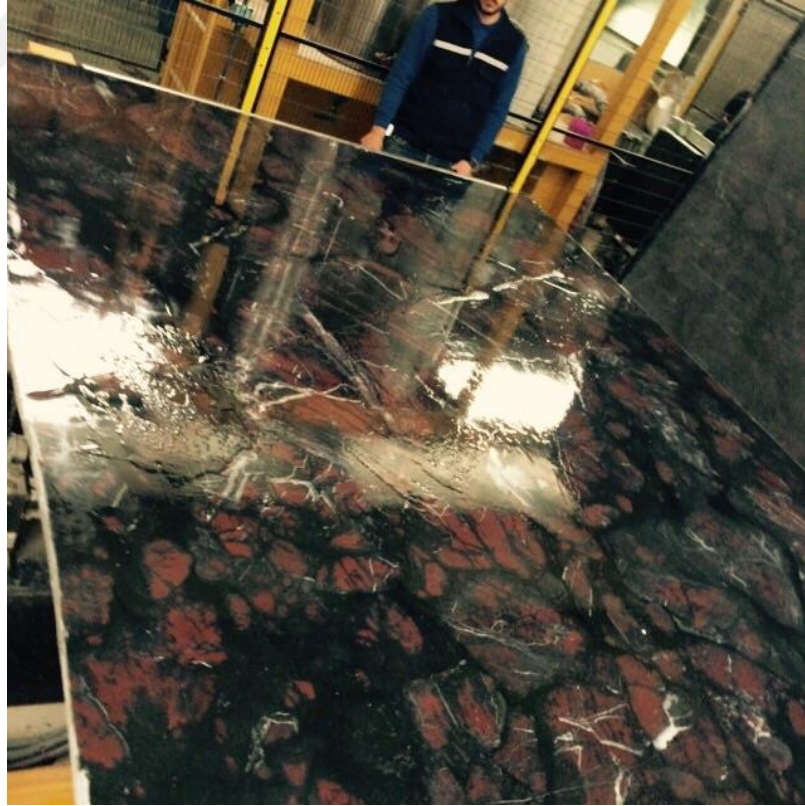
Şekil 1.43: Ön yüzeyi epoksilenmiş cila hattı için hazırlanmış levha örneği.
