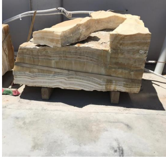
Şekil 3.1: Hasarlı blok mermer.
