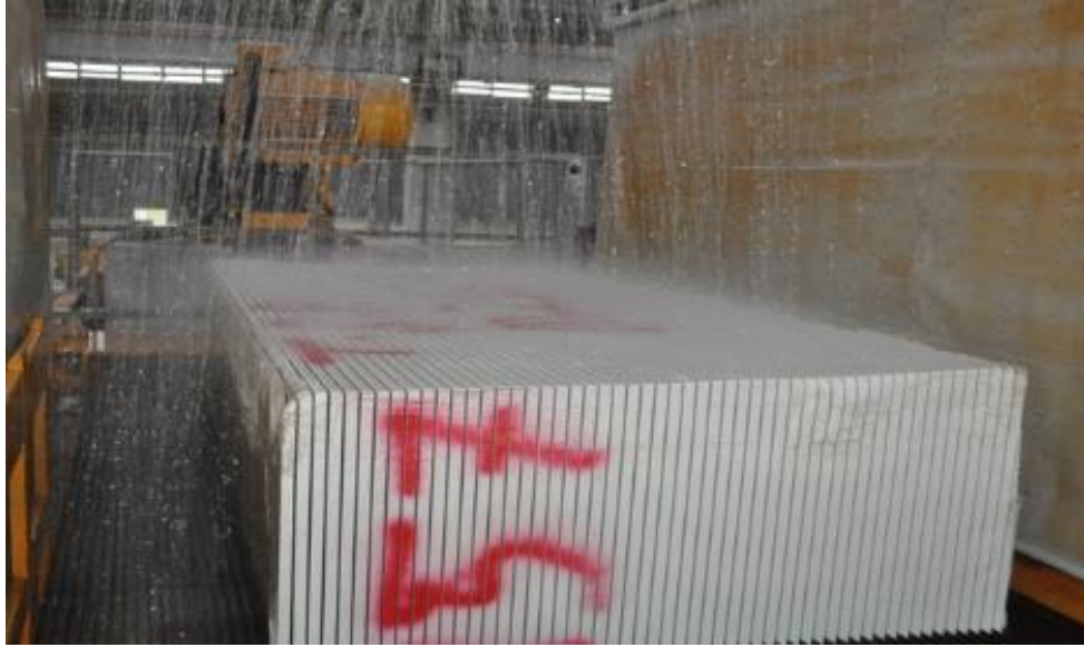
Şekil 1.34: Katrakta kesimi yapılan blok örneği (Url 1).
