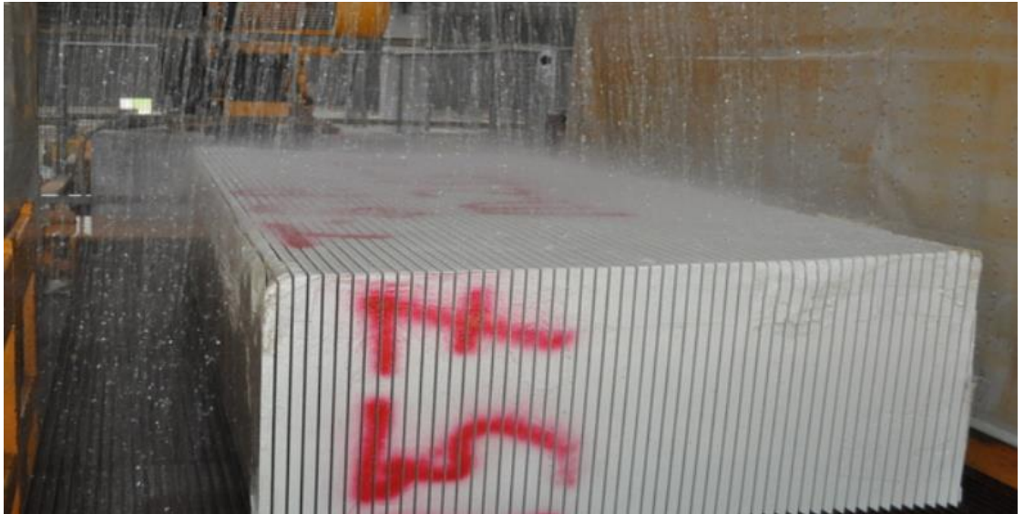
Şekil 3.9: Katrakta kesimi yapılan blok.
