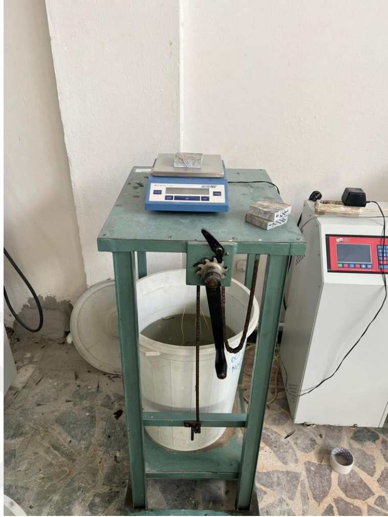
Şekil 4.3: Örneklerin arşimet terazisinde ölçümü.
