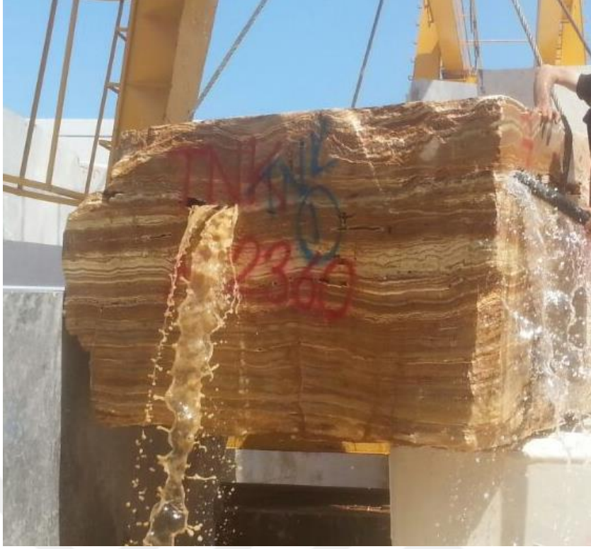
Şekil 1.5: Yıkaması yapılan blok örneği (Url 1).
