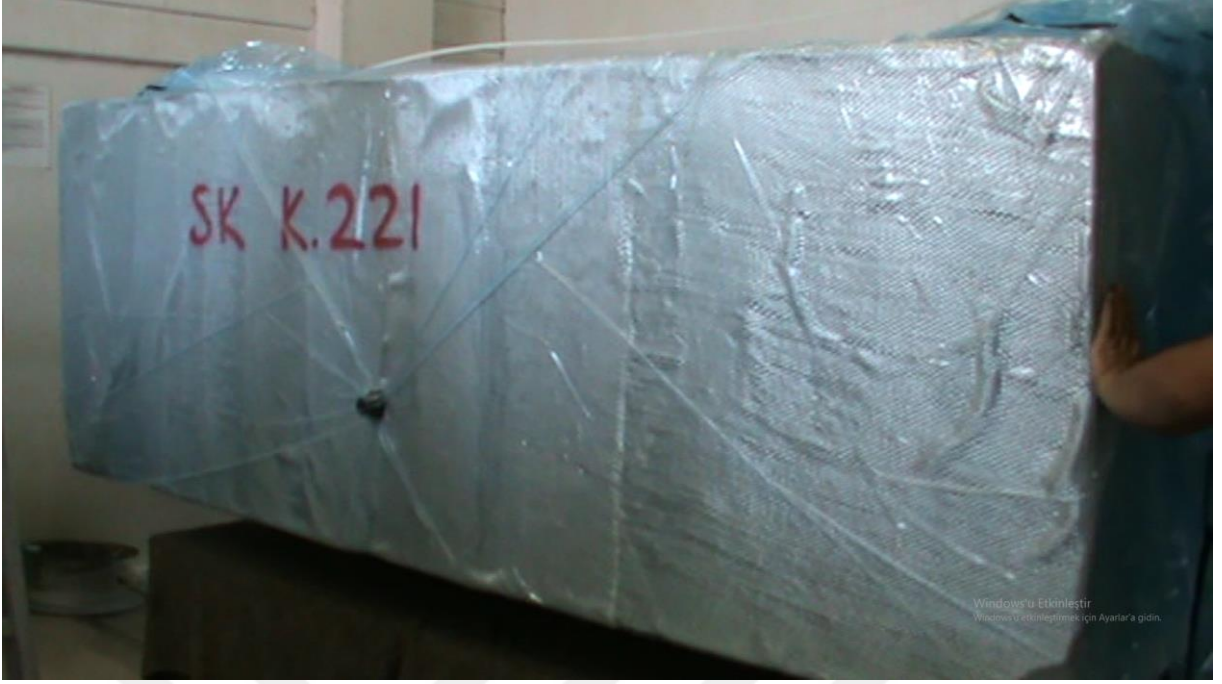
Şekil 1.27: Vakumlanma işleminin son safhası (naylon bloğa tamamen yapışmış durumda).
