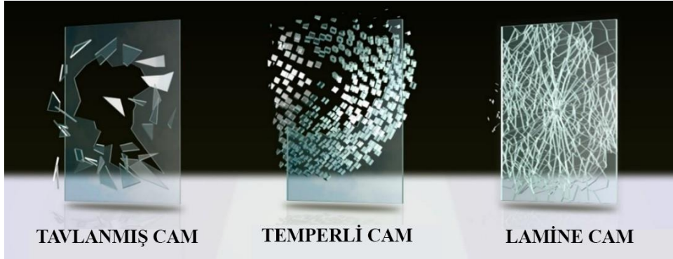
Şekil 2.11 : Tavlanmış cam, temperlenmiş cam ve lamine camın kırılma şekilleri (Url-10, 2022).
