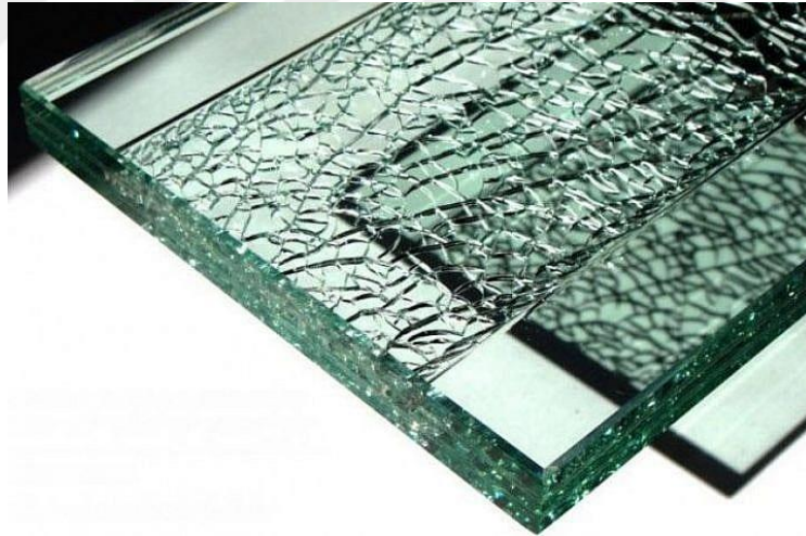
Şekil 2.10 : Temperlenmiş camın kırılma şekli (Url-9, 2022).
