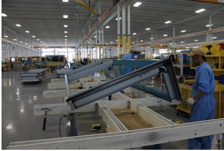
Şekil 4.65 : Fabrika ortamında köşe panel imalatı (Url-20, 2022).
