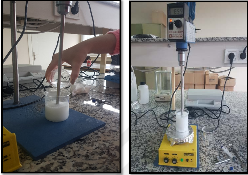
Resim 7: Mekanik karıştırıcıda emülsiyon hazırlanışı
