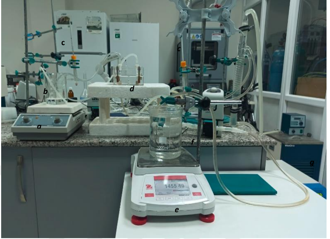
Şekil 3.1: İleri Ozmotik Membran Distilasyon Süreci
