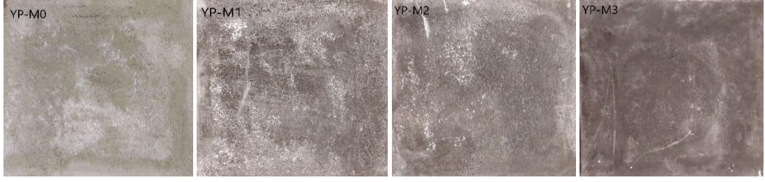
Şekil 4.25. Yeşil tüf esaslı ve polipropilen lifle takviye edilmiş kaplama malzemelerinin 90. gündeki görüntüleri.
