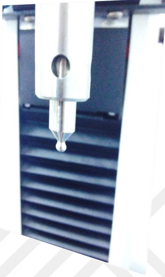
Şekil 3.8. Çalışmamızda kırma testi için kullanılan 3,6 mm çapa sahip küre şeklindeki paslanmaz çelik uç
