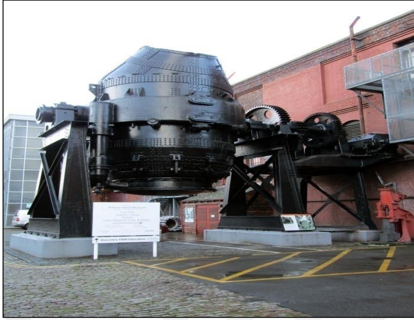
Fotoğraf 1: Çelik Üretim Sistemini Değiştiren Bessemer Konvertörü (Kaynak: Flickr, 2018)
