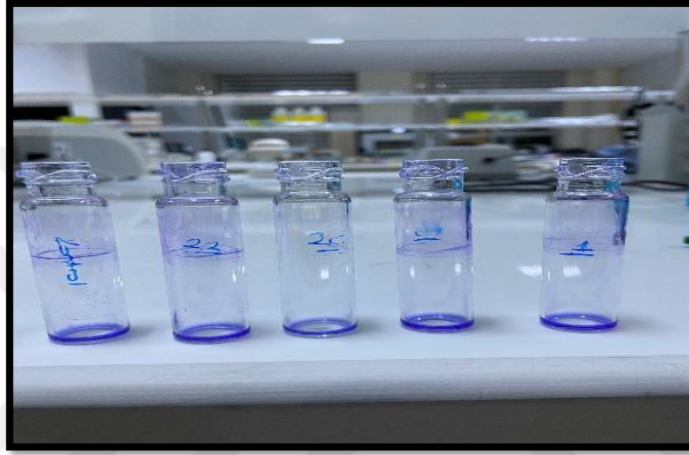
Şekil 3.3. Kalitatif cam tüp yöntemiyle biyofilm oluşumunun gözlenmesi
